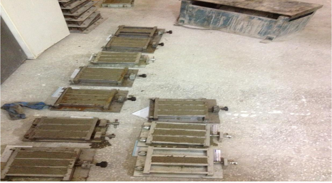
Şekil 3.4. Harcın Kalıba Yerleştirilmiş Hali
