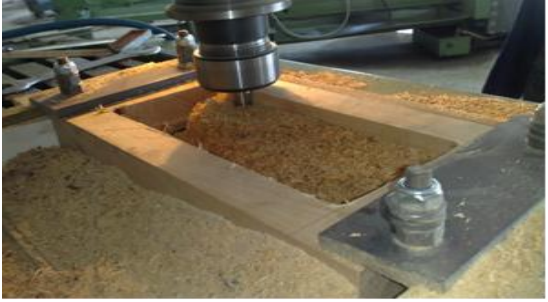
Resim 3.11. Gürgen malzemenin freze tezgahında işlenmesi
