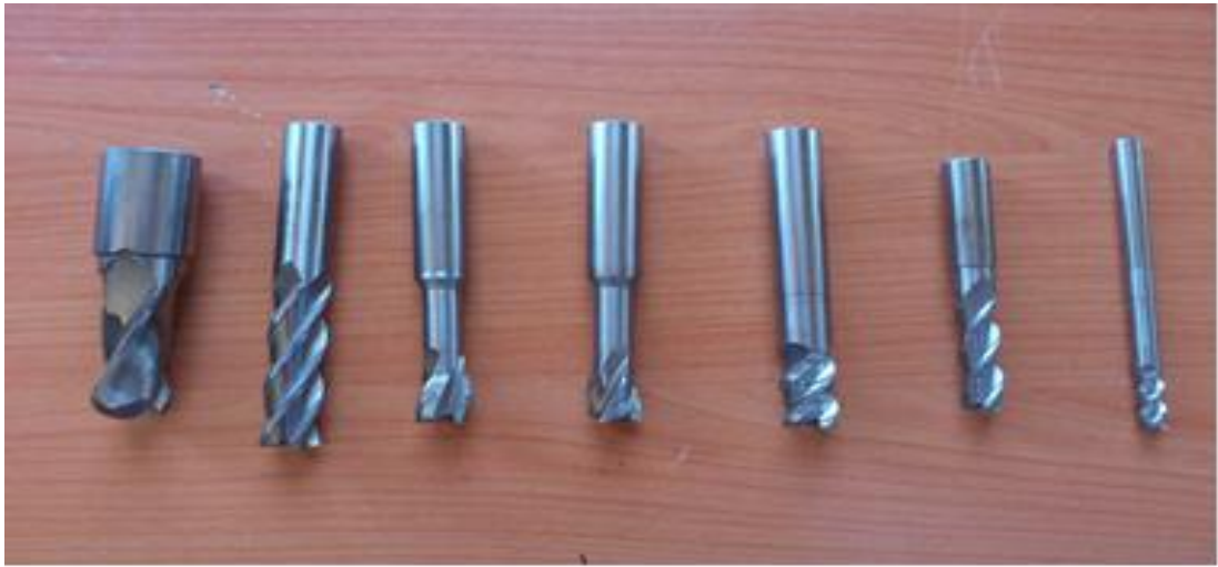
Resim 3.3. Özel profile üretilmiş freze çakıları
