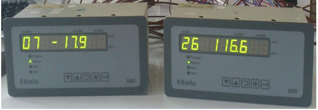
Resim 3.16. Elimko marka veri toplama ünitesi ( 32 kanallı data logger )
