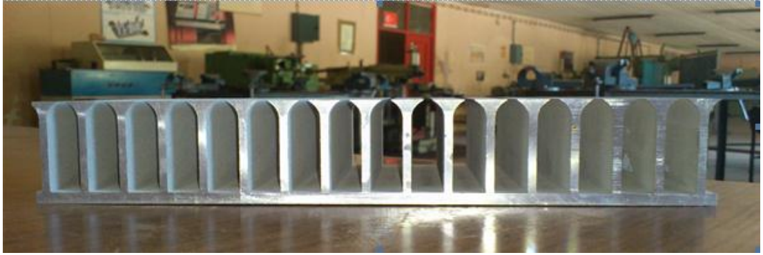
Resim 3.5. Tel erozyon tezgahında kesimi yapılmıř kanatık dizisi
