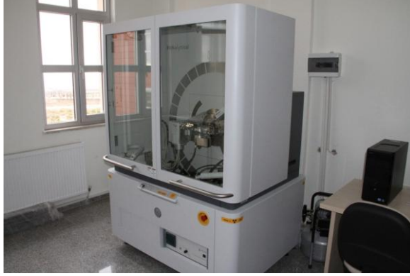
Şekil 3.4. PANalytical – Empyrean çok amaçlı X-Işını Difraktometresi (MP-XRD)
