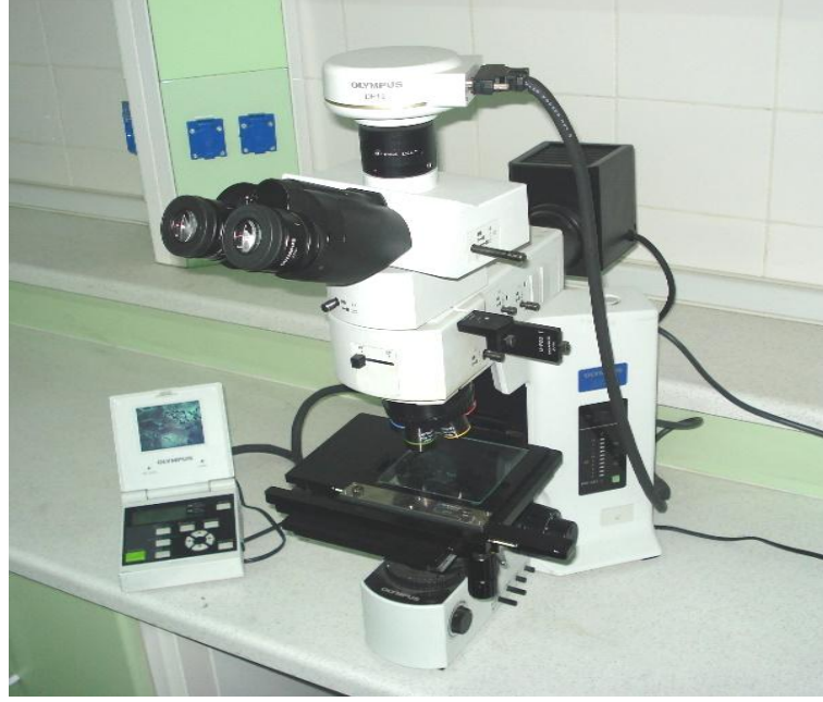
Şekil 3.3. Optik Mikroskop ve CCD Kameradan Oluşan Görüntü Sistemi
