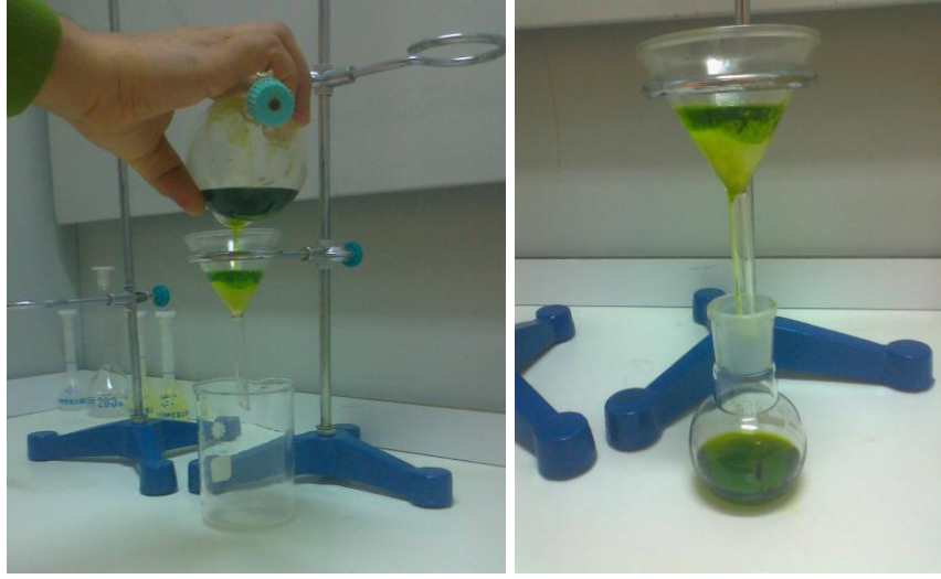
Şekil 5.20. Organik Fazın Sodyum Sülfattan Geçirilmesi
