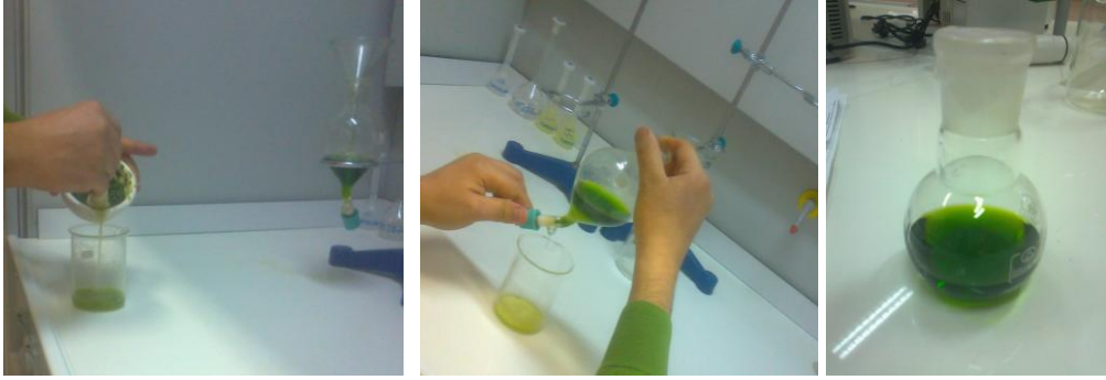
Şekil 5.19. Ayırma Hunisinde Sıvı-Sıvı Ekstraksiyonu
