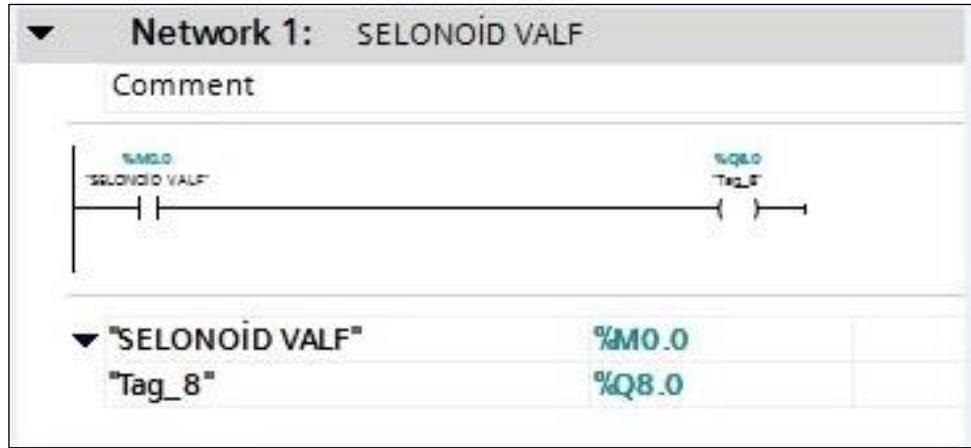
Şekil 4.4. Selenoid valfin kontrol paneline bağlantı kodları
