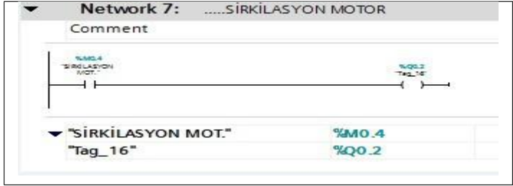
Şekil 4.22. Sirkülasyon pompasını kumanda eden PLC yazılım kodları
