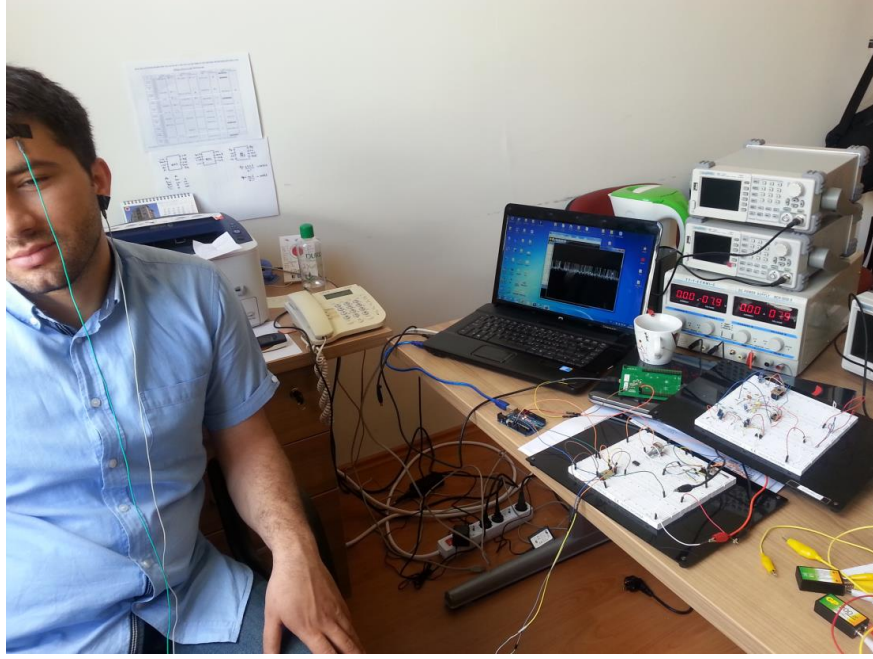
Şekil 6.73: EEG sinyalinin elde edilme düzeneği
