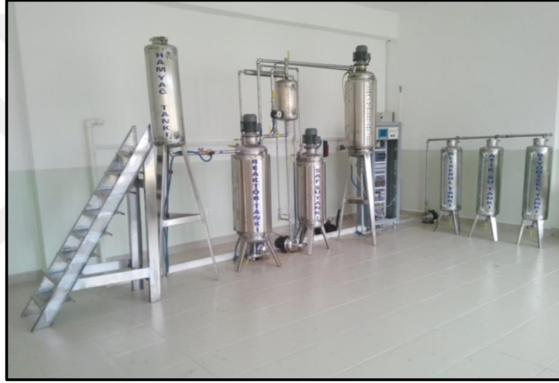
Şekil 3.27. PLC destekli pilot biyodizel üretim tesisi
