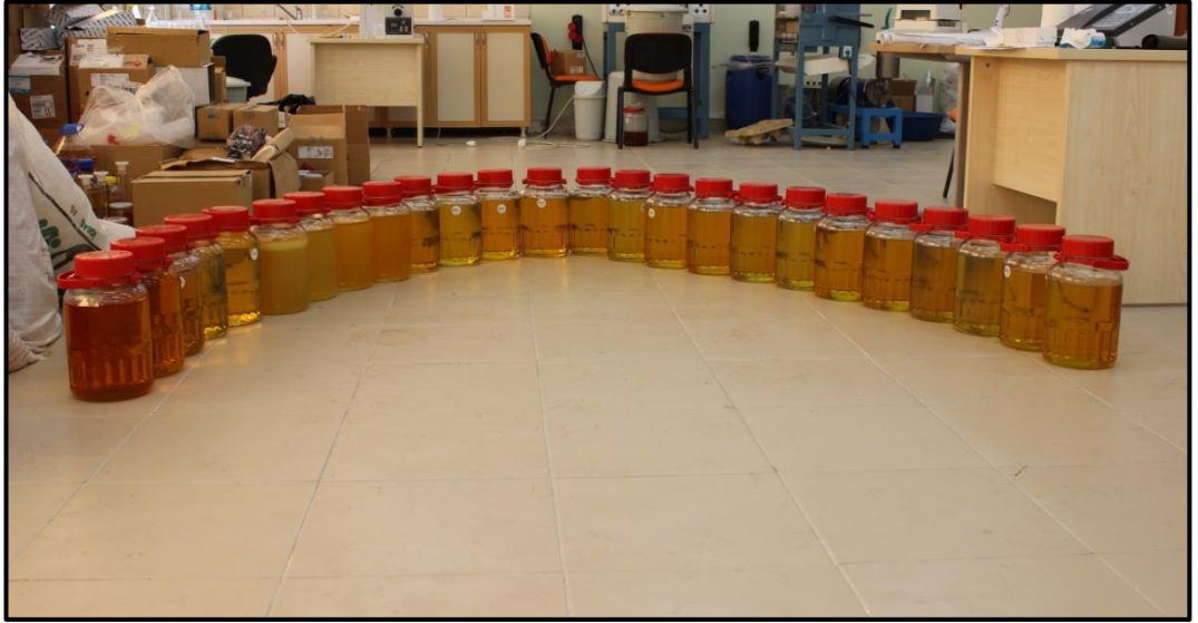
Şekil 3.43. Sarı hardal yağı, SHYB, ED ve hazırlanan karışım yakıtlar
