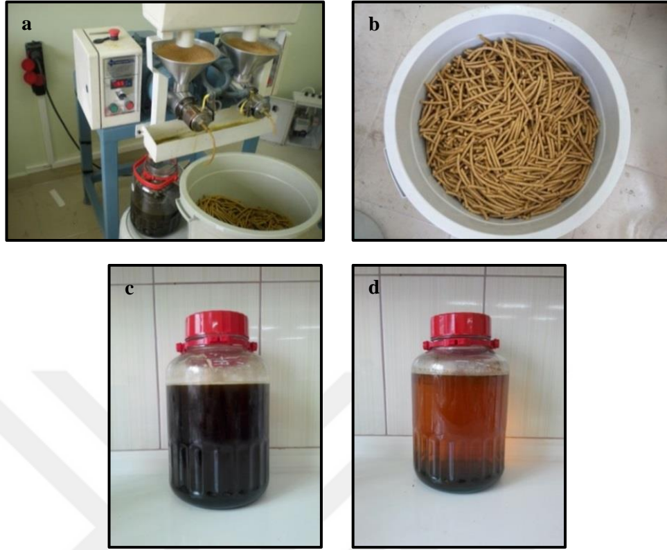
Şekil 3.41. (a) Sarı hardal tohumunun preslenmesi, (b) küspe, (c) ham yağ, (d) ham yağ ve çöken küspe parçacıkları
