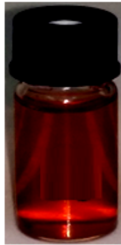
Şekil 3.8. DSSC'de kullanılmak üzere hazırlanan sıvı redoks elektroliti
