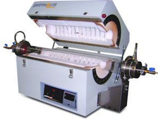
Şekil 3.4. Sinterleme işlemlerinde kullanılan tüp fırın
