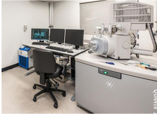
Şekil 3.12. TiO 2 tabakasının SEM görüntülerinin alınmasında kullanılan taramalı elektron mikroskobu
