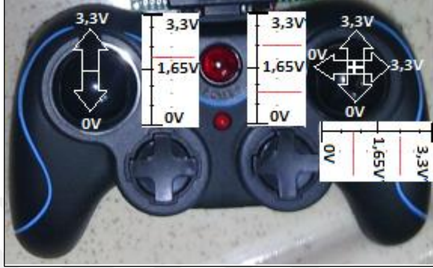
Şekil 5.30. Kumanda joysticklerinin konumlarına göre ürettiği gerilimler
