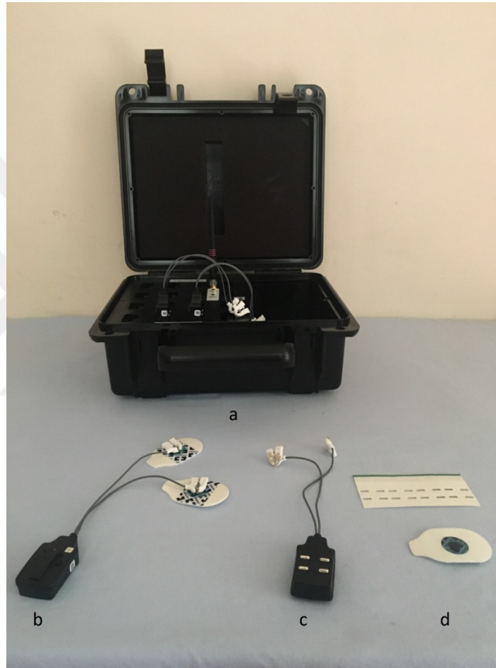
Fotoğraf 3.6. yEMG cihazı ve ekipmanları a) İstasyon b) Amplifikatör (sensör) c) Sensörün alttan görünümü d) Sensör sabitleyiciler ve Ag/AgCl elektrotlar
