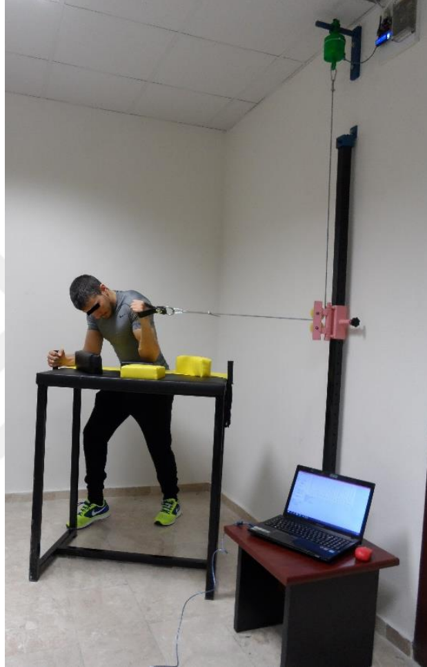
Şekil 3.1. Bilek güreşi bileşke izometrik kuvvet ölçümü.
