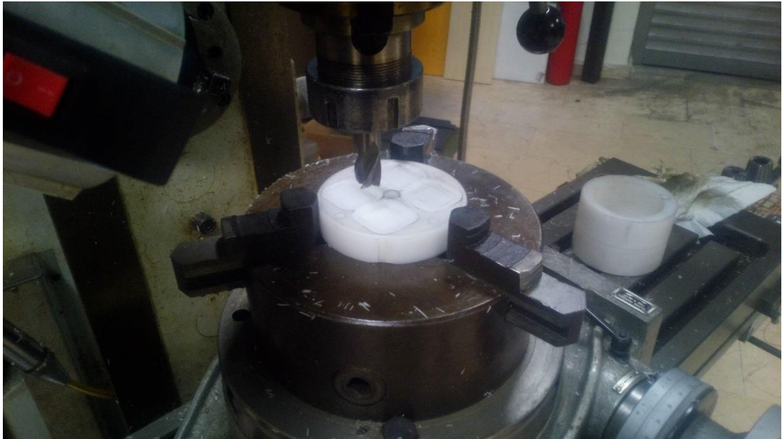
Şekil 2.7. Sensör alt ve üst kapaklarının frezede işlenmesi.
