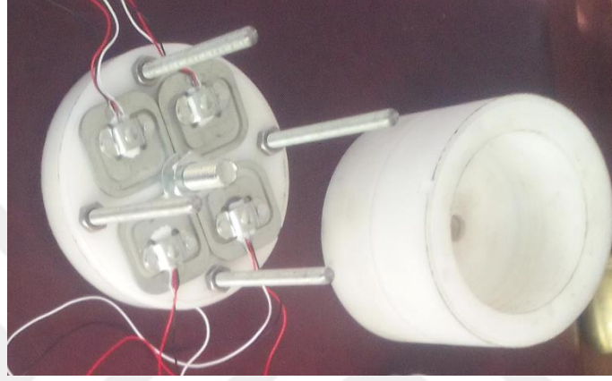
Şekil 2.8. Yük hücrelerinin kuvvet sensörünün alt kapağına yerleştirilmesi.
