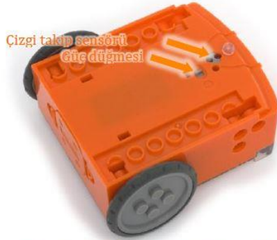
Edison'un güç düğmesi ve çizgi takip sensörü
