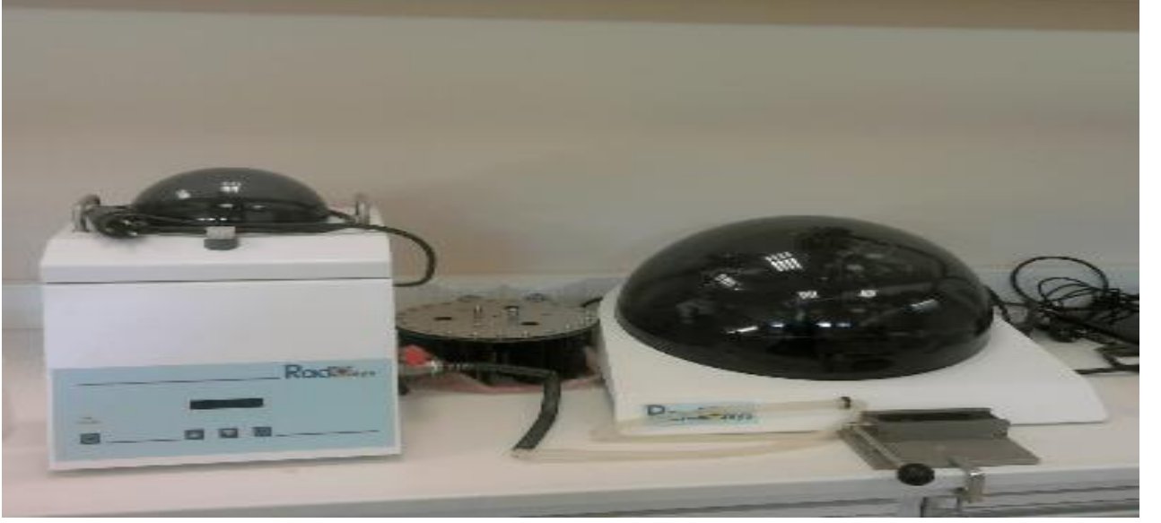
Şekil 3.4. RADOSYS Radon algılama sistemi
