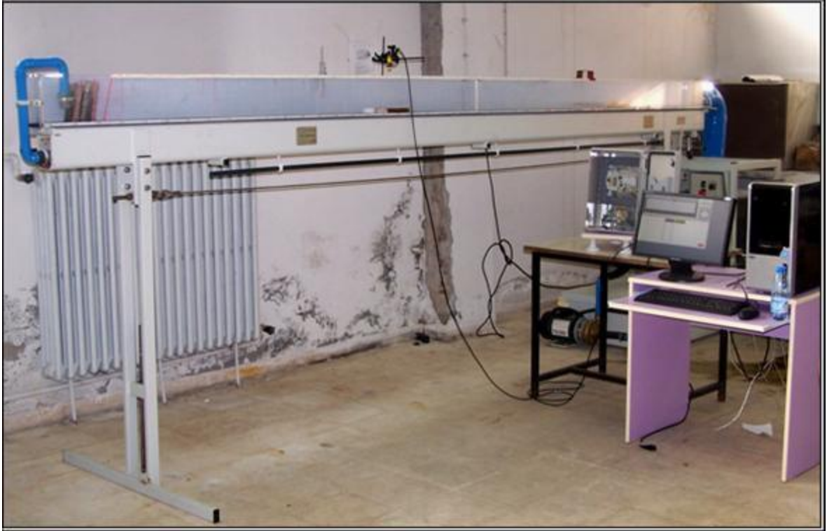
Şekil 3.1. Akım derinliği ölçümünde kullanılan deney düzeneği (Öztürkmen, 2008)
