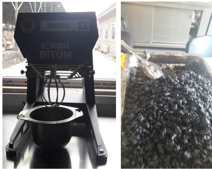
Şekil 3.18. Bitüm Karıştırma Mikseri ve Hazırlanan Taş Mastik Asfalt
