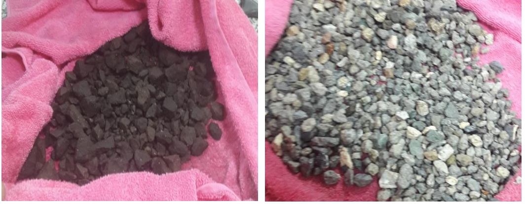
Şekil 3.7. Doygun - Kuru Yüzey Durumuna Getirilen Ahlat Taşı ve Perlit Agregaları
