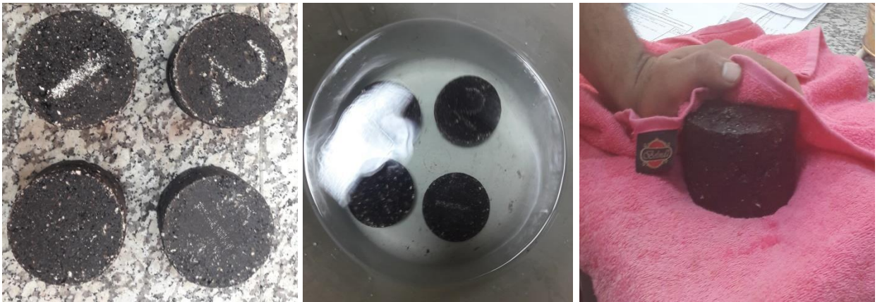
Şekil 3.20. Briket Görünümleri, Kuru, Suda ve Doymun- Kuru Yüzey
