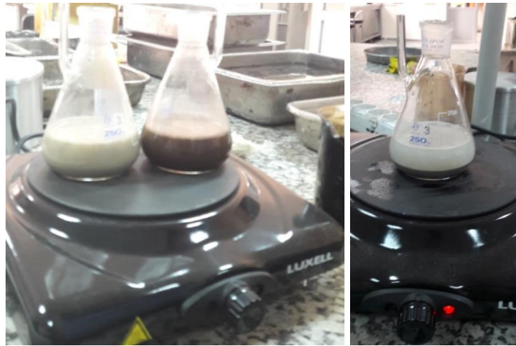
Şekil 3.11. Filler Malzemenin Isıtılarak Vakumlanması
