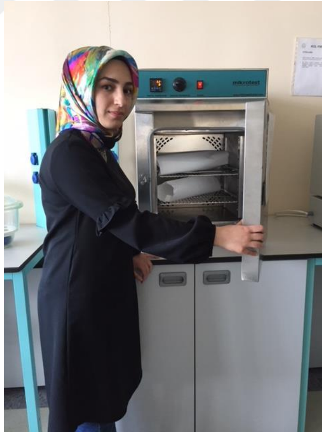
Şekil 5.11. Saf Sudan Geçirilen Örneklerin Etüvde Kurutulması
