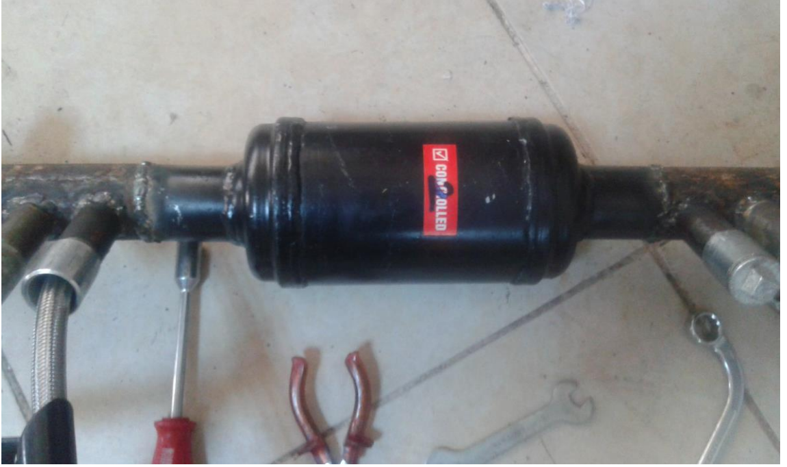
Şekil 4.3. (2) nolu konvertörün DPF girişinde ölçüm yapma
