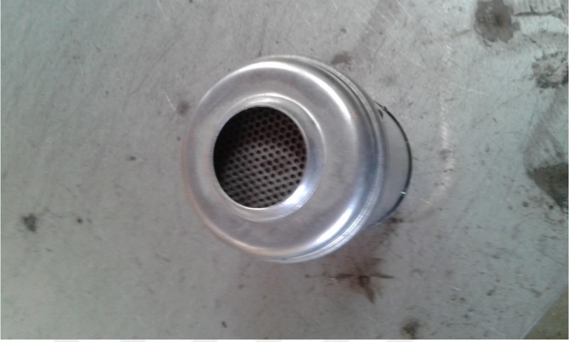
Şekil 3.8. Konvertör uç kapağı
