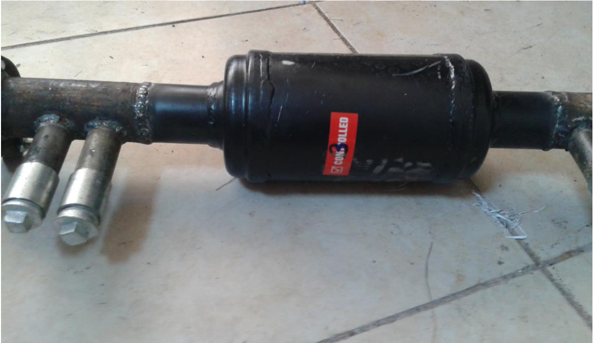
Şekil 4.5. Genleştirilmiş perlit ile yapılan konvertörün DPF girişinde ölçüm yapma
