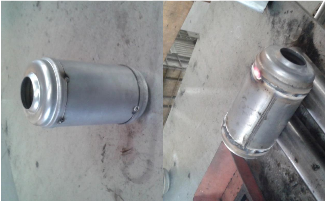
Şekil 3.11. Filtre malzemesi doldurulan konvertörün iki ucunun kapakla kapatılması
