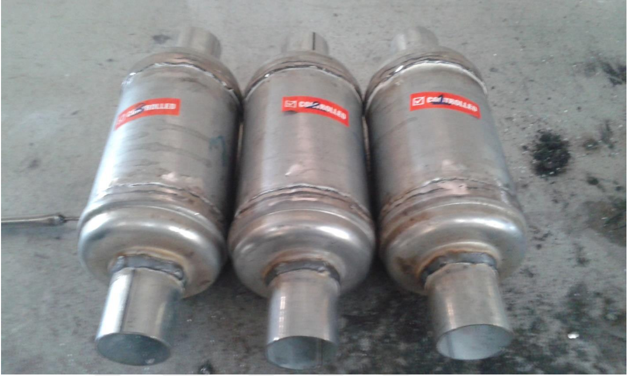
Şekil 3.12. Uçlarına bağlantı boruları eklenen konvertörler
