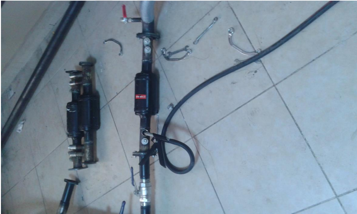
Şekil 4.1. Pomza ile yapılan konvertörün DPF girişinde ölçüm yapma
