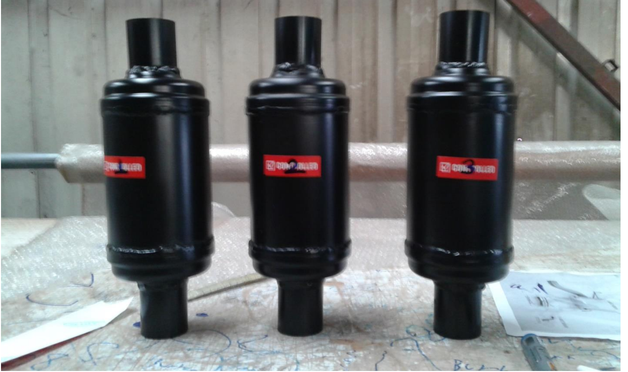
Şekil 3.13. Boyama işlemi sonrası konvertörler
