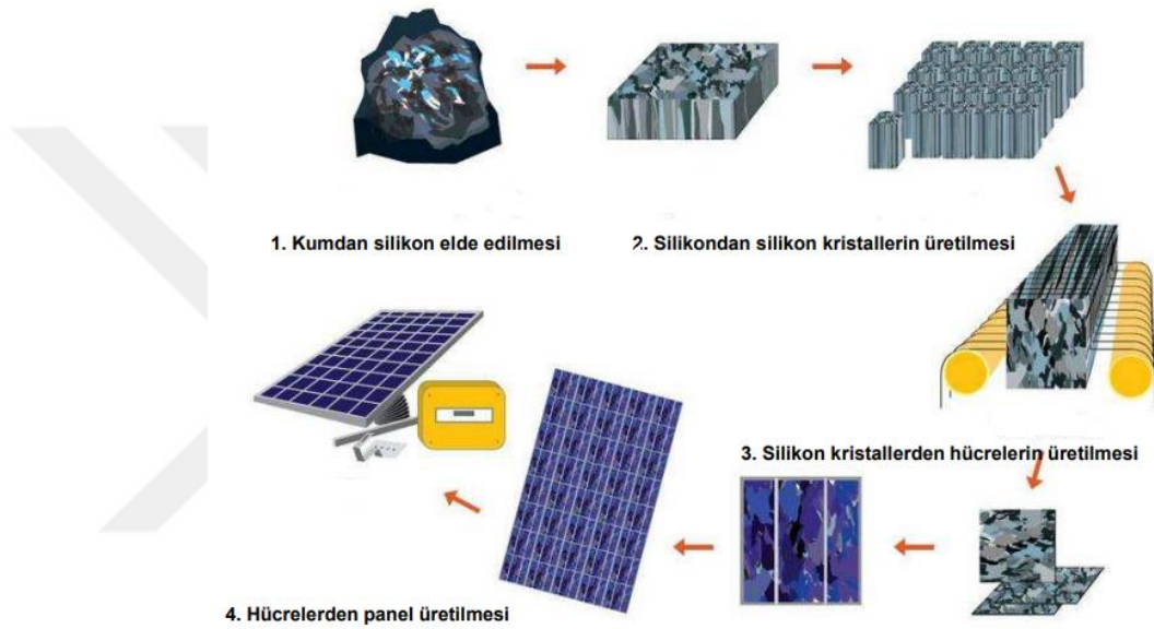
Şekil 3.10. FV hücre üretim bandı
