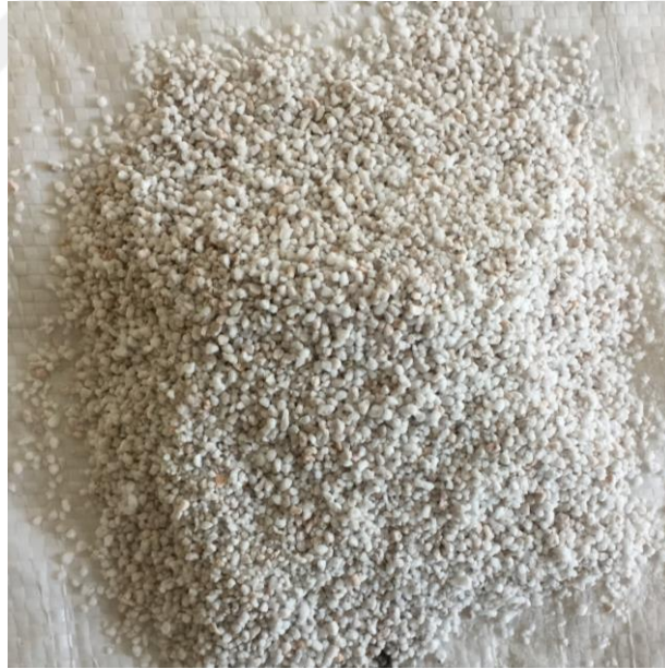
Şekil 2.2. 0-4 mm genişletilmiş perlit agregası
