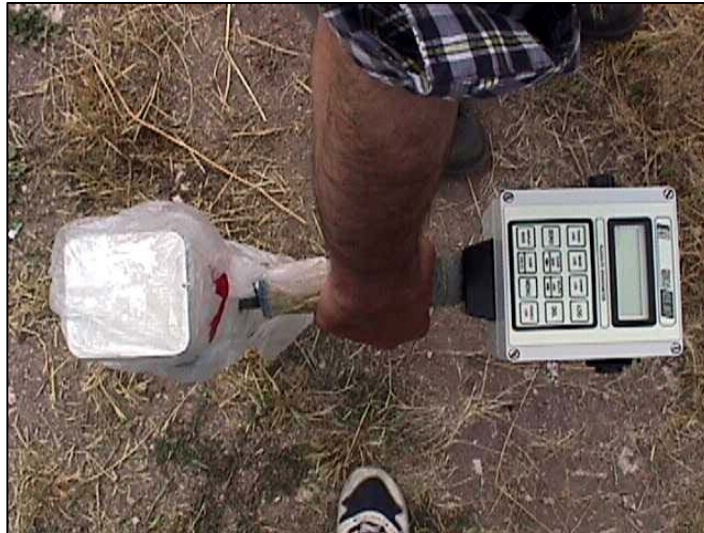
Şekil 2.11. Amorium antik kentinde kullanılan gradiometreden bir görünüm (Yiğit, 2005)
