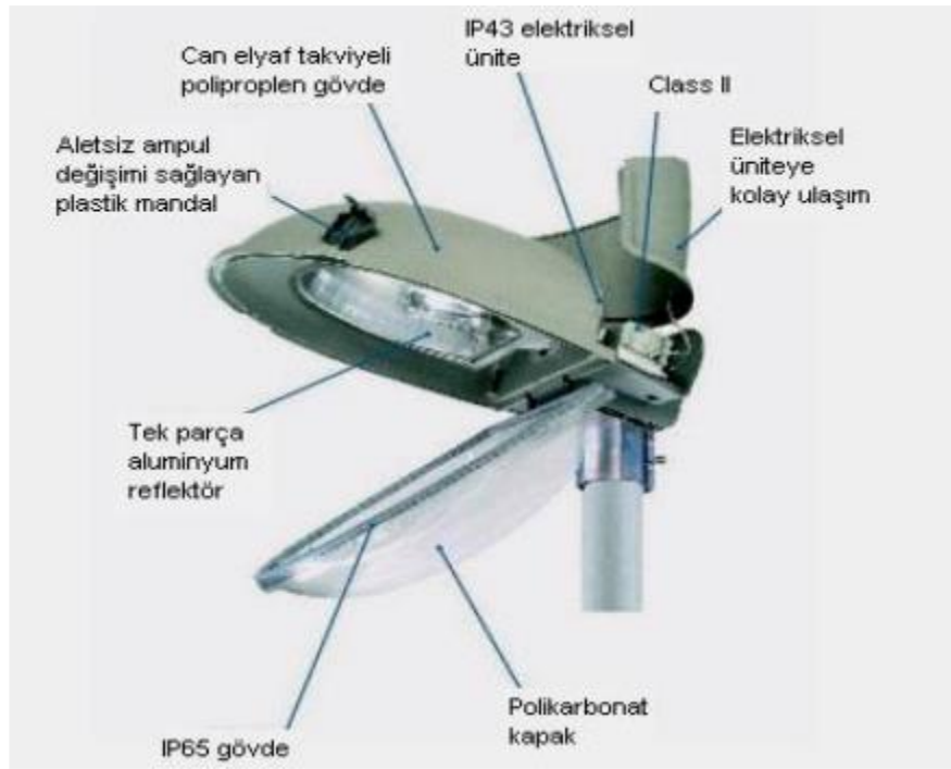
Şekil 2.32. Dış Aydınlatma armatürünün yapısı
