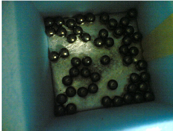
Şekil 1.20. Kalıplara dökülen sıvı haldeki cerrobend alaşıma rastgele eklenen kurşun bilyeler [28].
