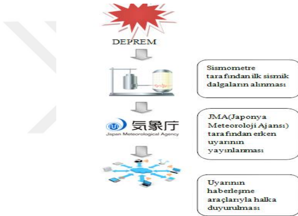
Şekil 2.6. Deprem erken uyarı sistemi akış şeması [44]
