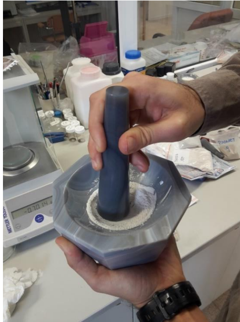
Resim 113: Havan İçerisinde Örneğin Homojen Hale Getirilmesi
