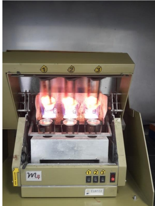
Resim 117: Örneklerin Karıştırılarak Eritilmesi
