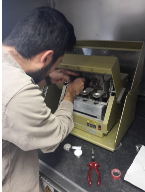
Resim 115: XRF Numune Ergitme Cihazı ve Örneklerin Yerleştirilmesi
