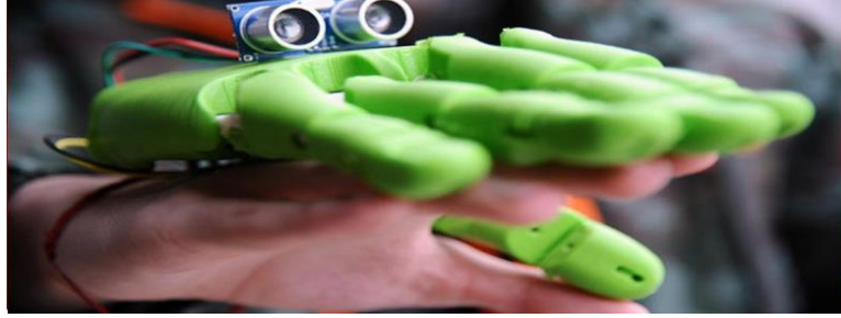
Şekil 9: Görme Engelliler İçin Tasarlanmış Akıllı Eldiven
