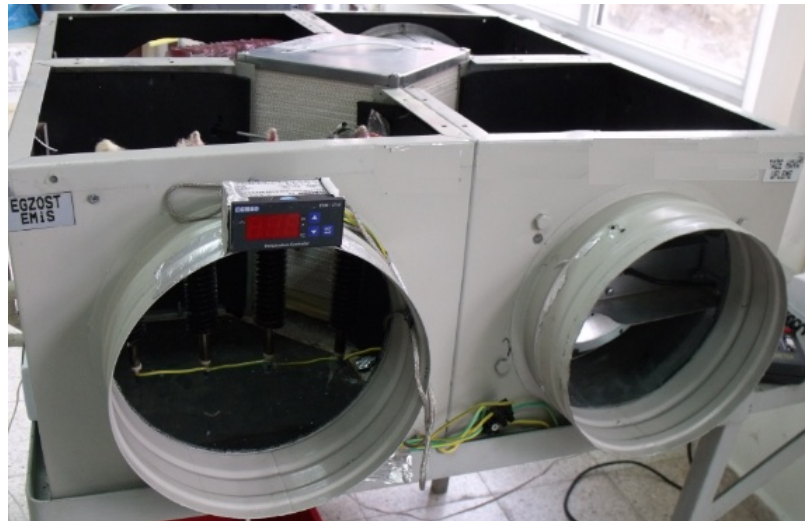
Şekil 7.15. Deneyde kullandığımız ısı geri kazanım cihazı.
