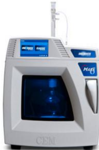
ekil 3.1. Sentez çalı malarında kullanılan CEM-Mars6 model mikrodalga sentez reaktörü.
