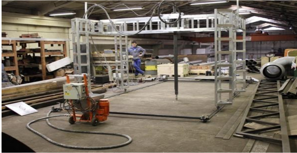
Şekil 3.2. Üç boyutlu beton yazıcı cihazı (yhbm, 2016).
