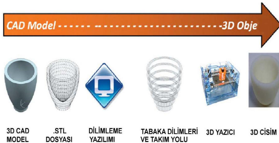
Şekil 2.5. Bir 3D CAD modelin katmanlı üretim süreci (Campbell, 2011).
