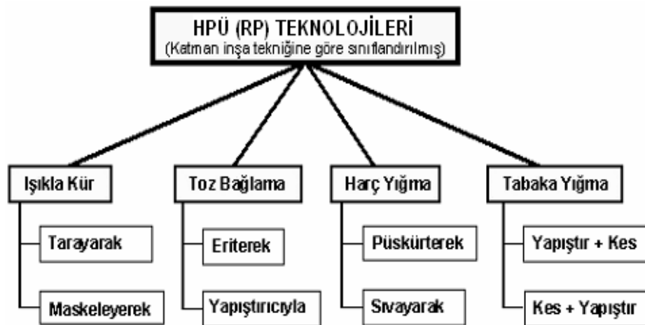
Şekil 2.1. 3 boyutlu yazıcı cihazları inşa tekniğine göre sınıflandırılması (Özuğur, 2006).
