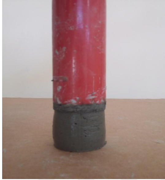
Şekil 6.3. Beton harcın pompa ağzından çıkış görüntüsü.
