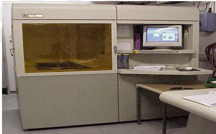
Şekil 2.2. 3D Systems firmasının SLA5000 modeli Stereolithography cihazı (Kan, 2006).
