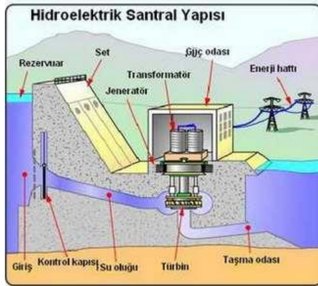
Şekil 1.4. Hidroelektrik santral kesiti (www.teknikvideo.net).
