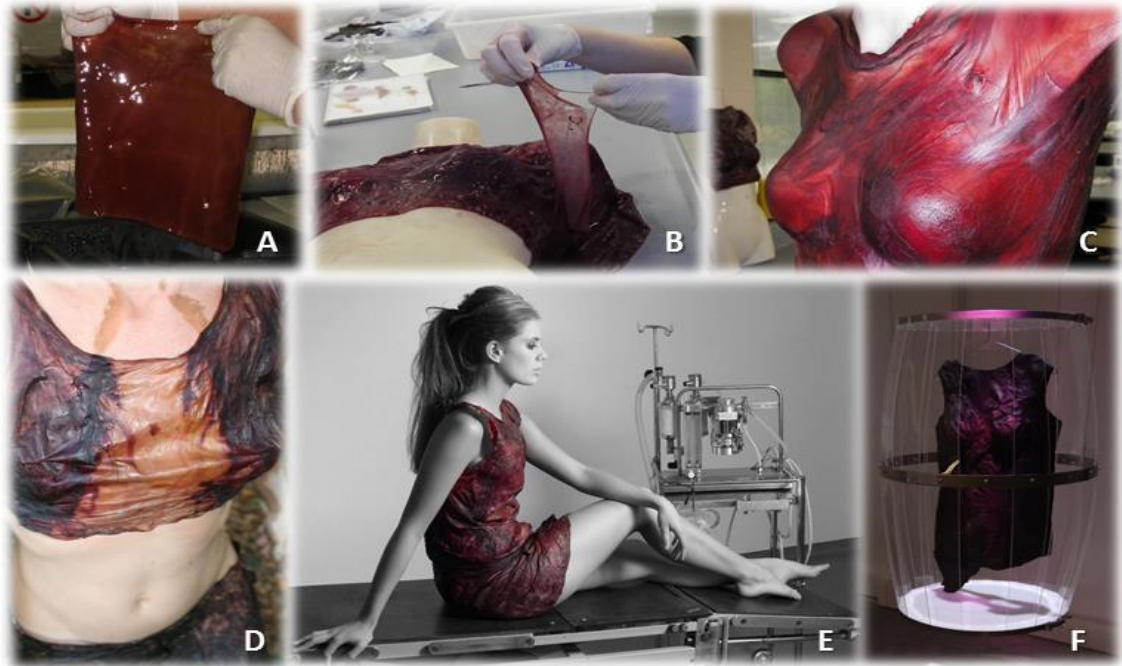
Şekil 2. 12. Mikrobiyal selülozdan oluşan dokunmamış ürünler. . A: Kültür ortamından mikrobiyal selülozun toplanması, B ve C: Selülozik materyalin yapı iskelesi üzerine alınması ve kurutulması, D: Beslenme ile kontrolü sağlayanabilen bir renk çeşitliliği E ve F: Şarap fermentasyonundan elde edilen elbise (Çobanoğlu, vd., 2013).
