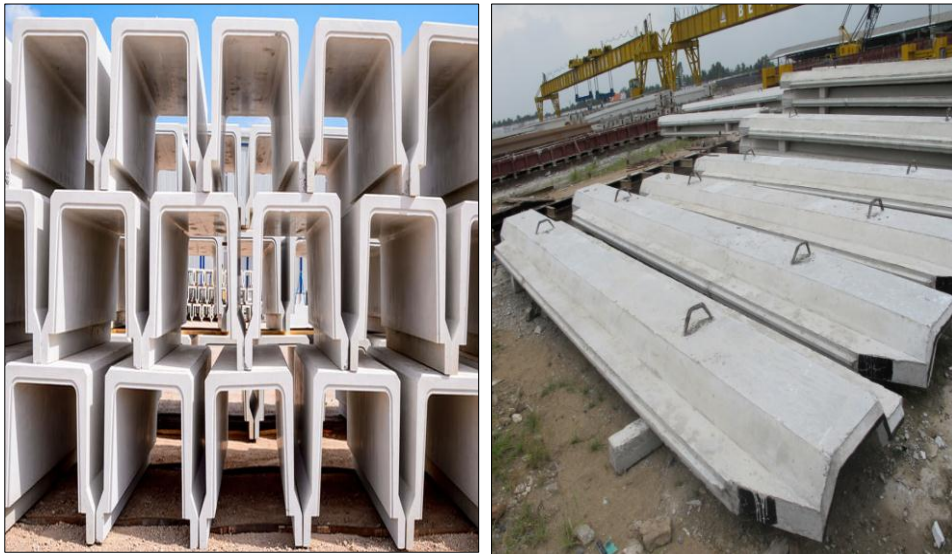
Şekil 2.13. Farklı ebat ve şekillerde imal edilmiş betonarme palplanşlar.
