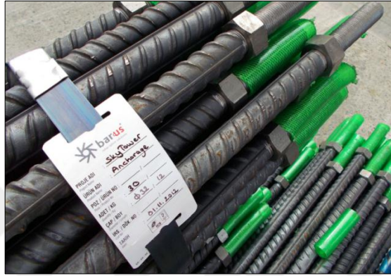
Şekil 2.7. Zemin çivileri (pasif ankraj).
