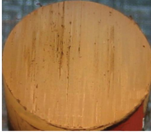
Şekil 4.4. Poliamid 66 yüzeyine gömülü abrazif partiküller (Abdelbary, 2015).
