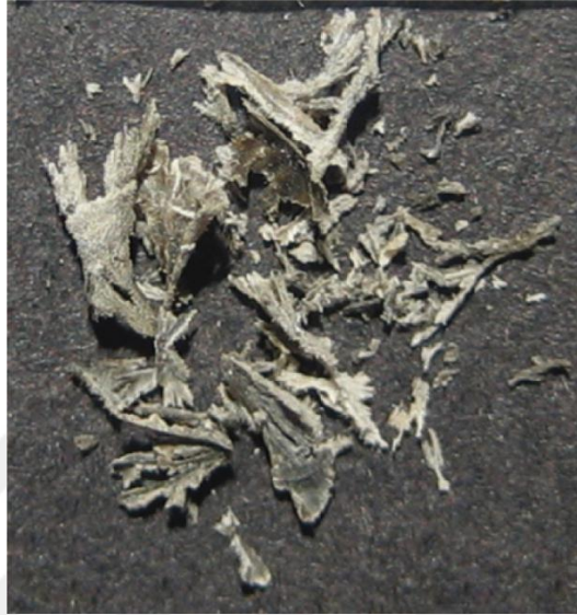
Şekil 4.6 Delaminasyon aşınma tabakaları (50X) (Abdelbary, 2015).
