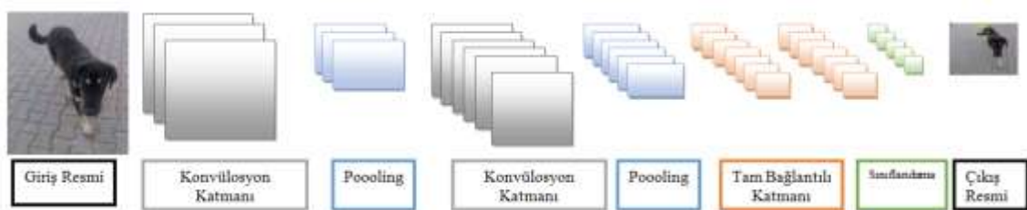
Şekil 3.5. Evrişimsel sinir ağı (CNN) yapısı.
