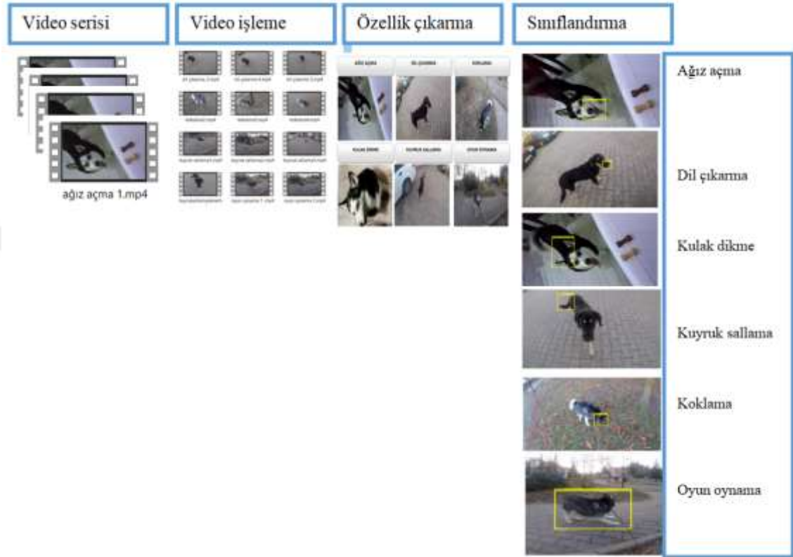
Şekil 3.1. Önerilen tez çalışmasının işlem adımlarını ve yöntemlerini gösteren blok diyagram.
