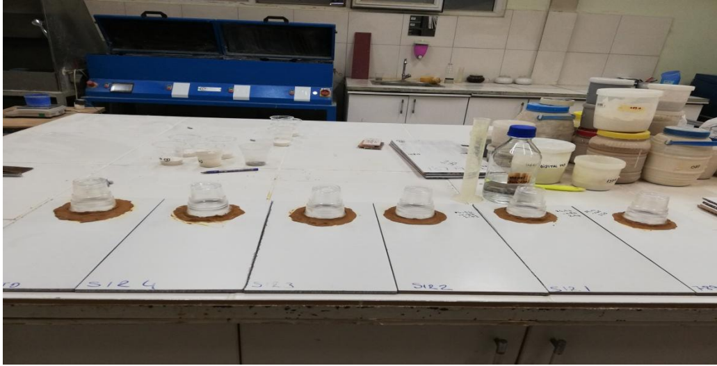
Şekil 4.8. HCl ile asit testi uygulanmış yeni sır çalışmaları.
