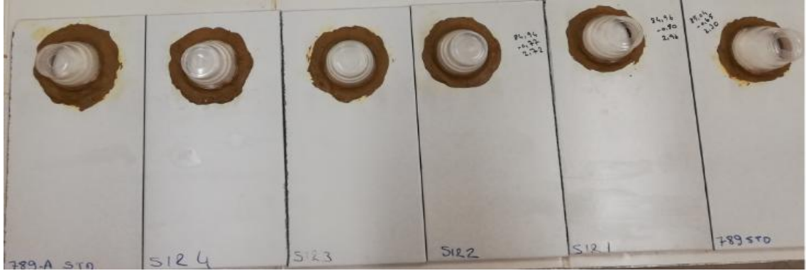
Şekil 4.7. Pişirilen Karolara Uygulanan Asit Testi.
