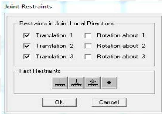
Şekil 6.7. SAP 2000 programında mesnet koşullarının oluşturulması.
