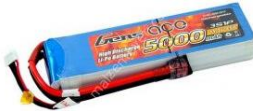
Şekil 2.7. LiPo pil (12V 3S 5000mAh).
