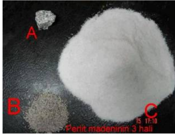
Şekil:2.5. Kayaç haldeki perlit (a), ham perlit (b) ve genişletilmiş perlitin (c) görünümü.
