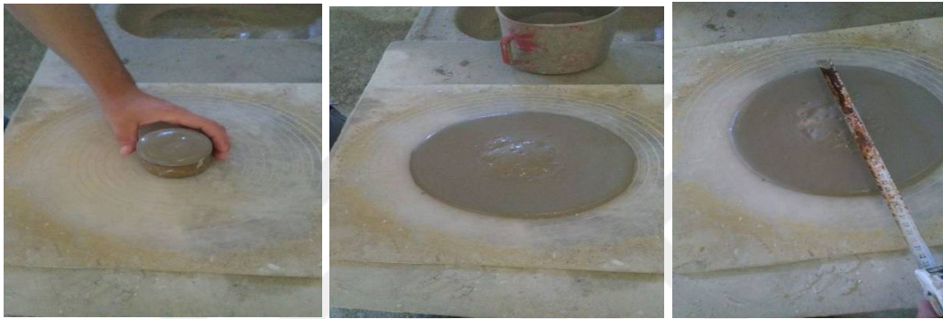
a) Vikat kalıbının doldurulması b) Numunedeki yayılma c) Yayılma çapının ölçümü
