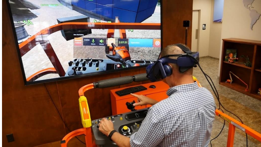
Şekil 3.1.9. Etkileşimli iş makinesi simülatörü örneği (Foregex, 2017).
