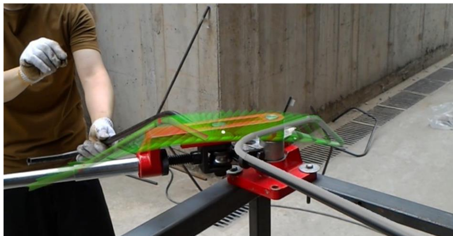
Şekil 3.14. Şantiye ortamında holografik görüntü örneği (Fologram, 2019).
