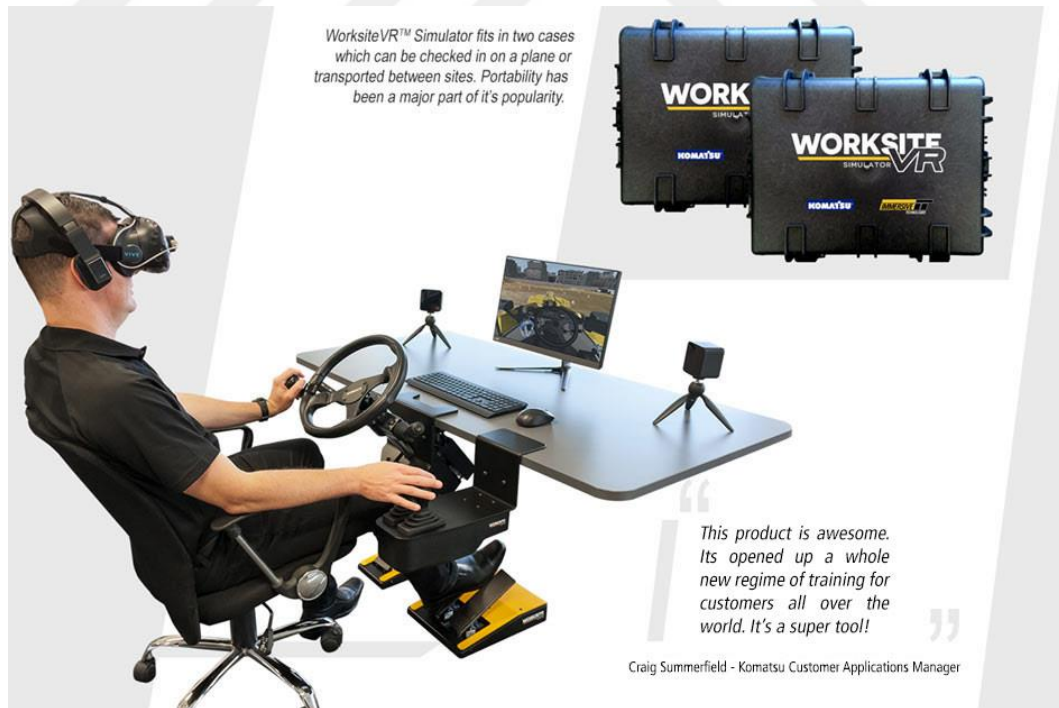
Şekil 3.18. Worksite ile iş makinesi eğitim simülatörü (Worksite, 2019).
