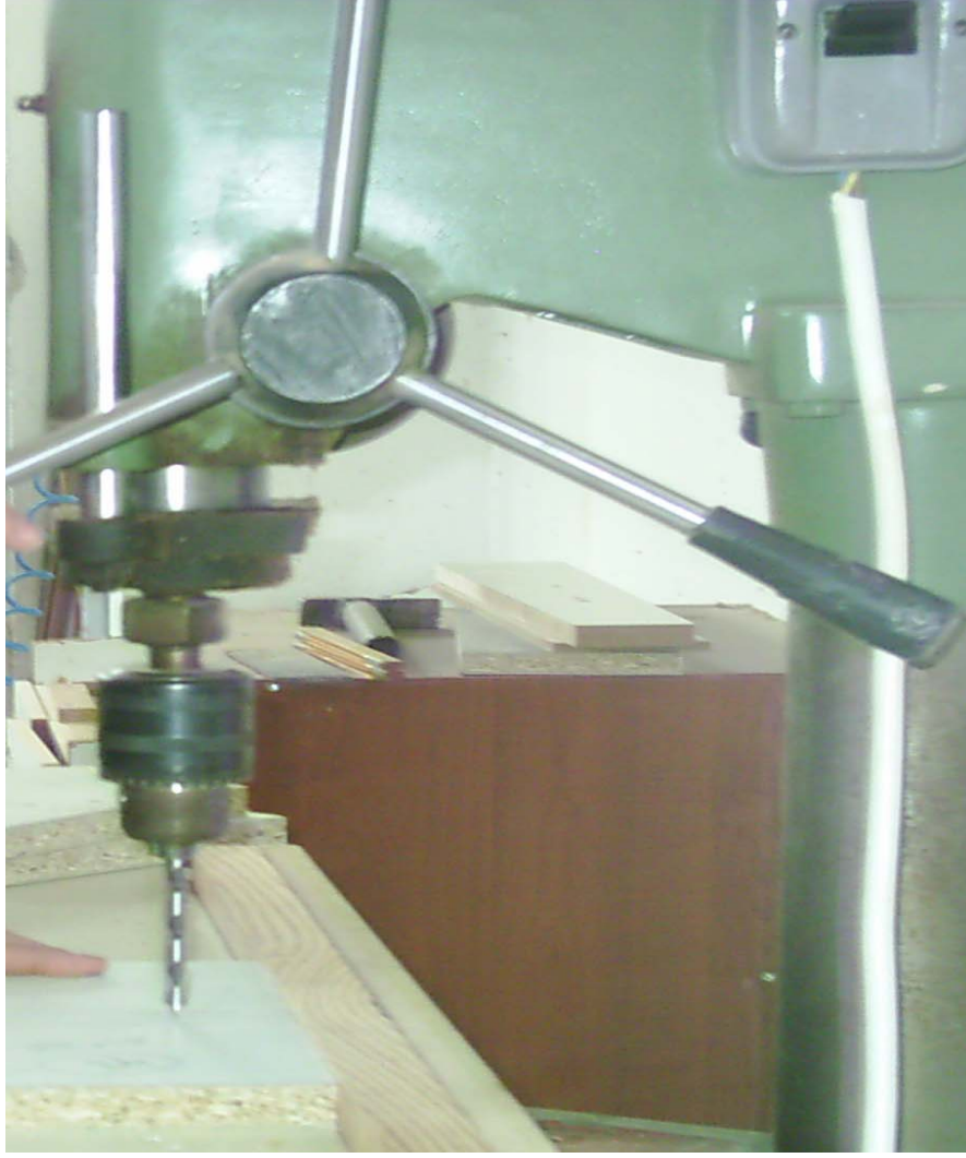
Şekil 4.7 Deney numunelerine havşa açılması.
