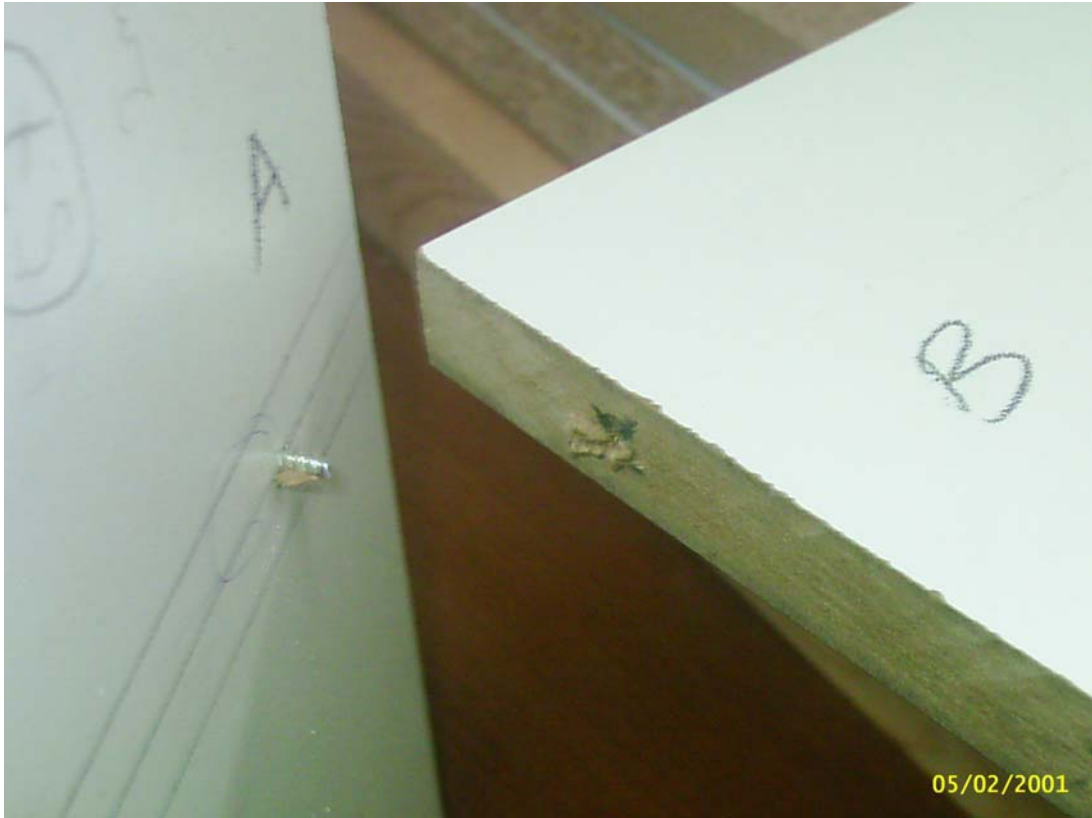
Şekil 5.7 Eğilme deneyinde 2 mm KD - 3,5 mm vida MDF lamda oluşan deformasyon.
