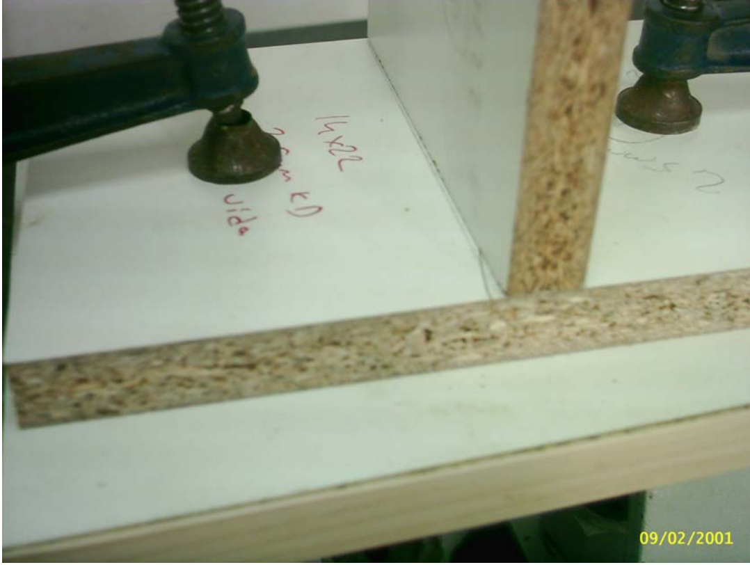
Şekil 5.18 Çekme deneyinde 2,5 mm KD - 4 mm vida suntalamda oluşan deformasyon.
