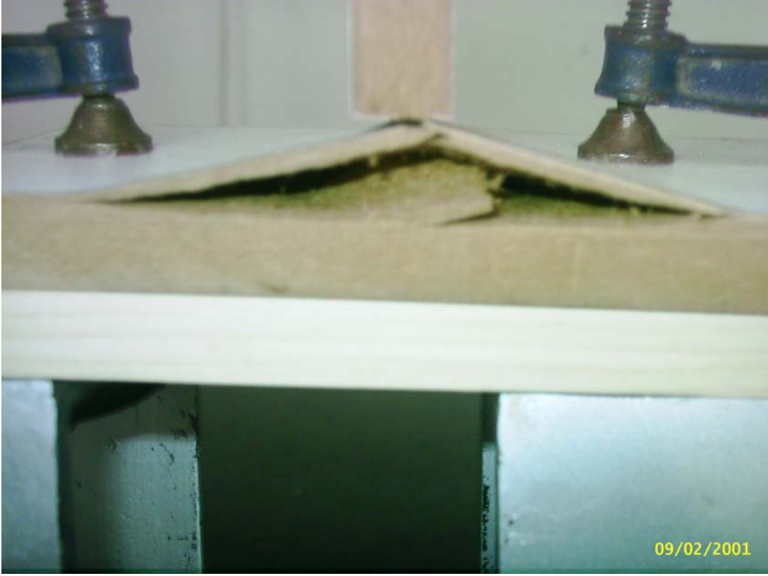
Şekil 5.20 Çekme deneyinde 2,5 mm KD - 4 mm vida MDFLamda oluşan deformasyon.
