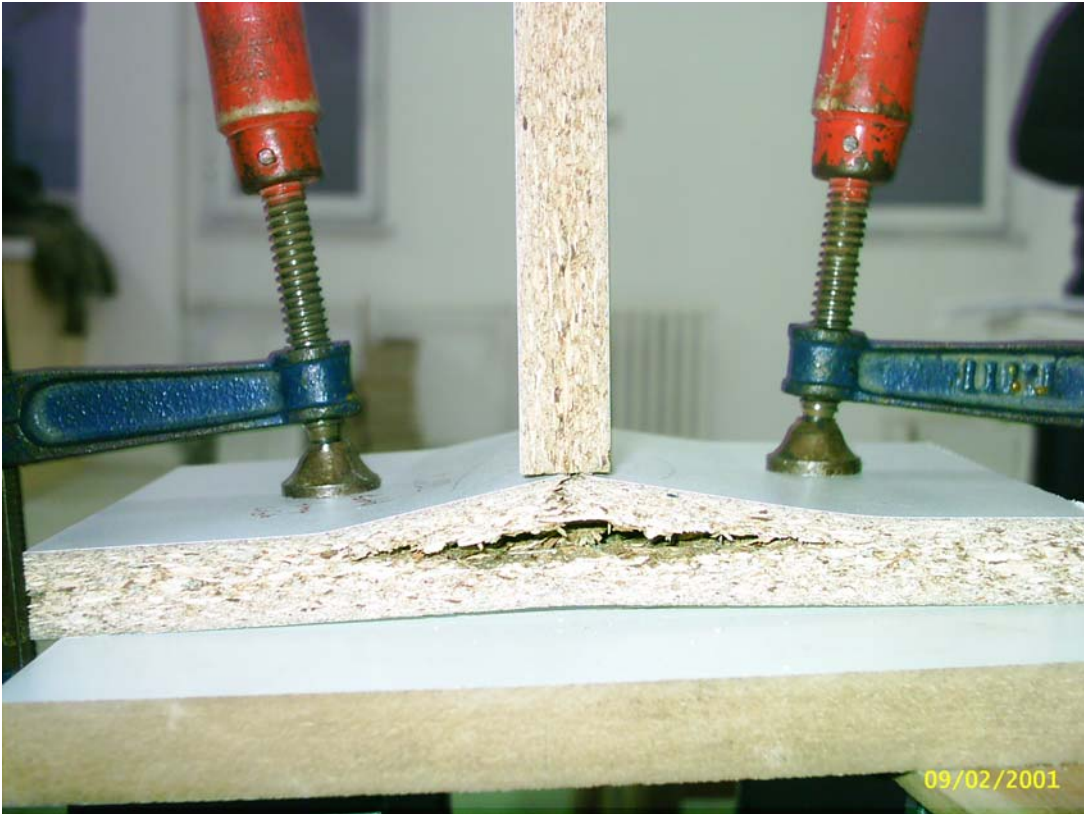
Şekil 5.21 Çekme deneyinde Kontrol - 4 mm vida sunta lamda oluşan deformasyon.
