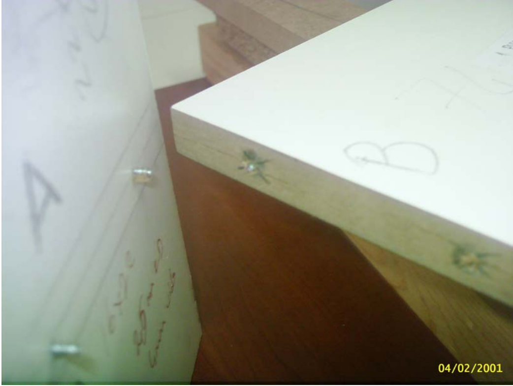
Şekil 5.4 Eğilme deneyinde 2,5 mm KD - 4 mm vida MDFLamda oluşan deformasyon.
