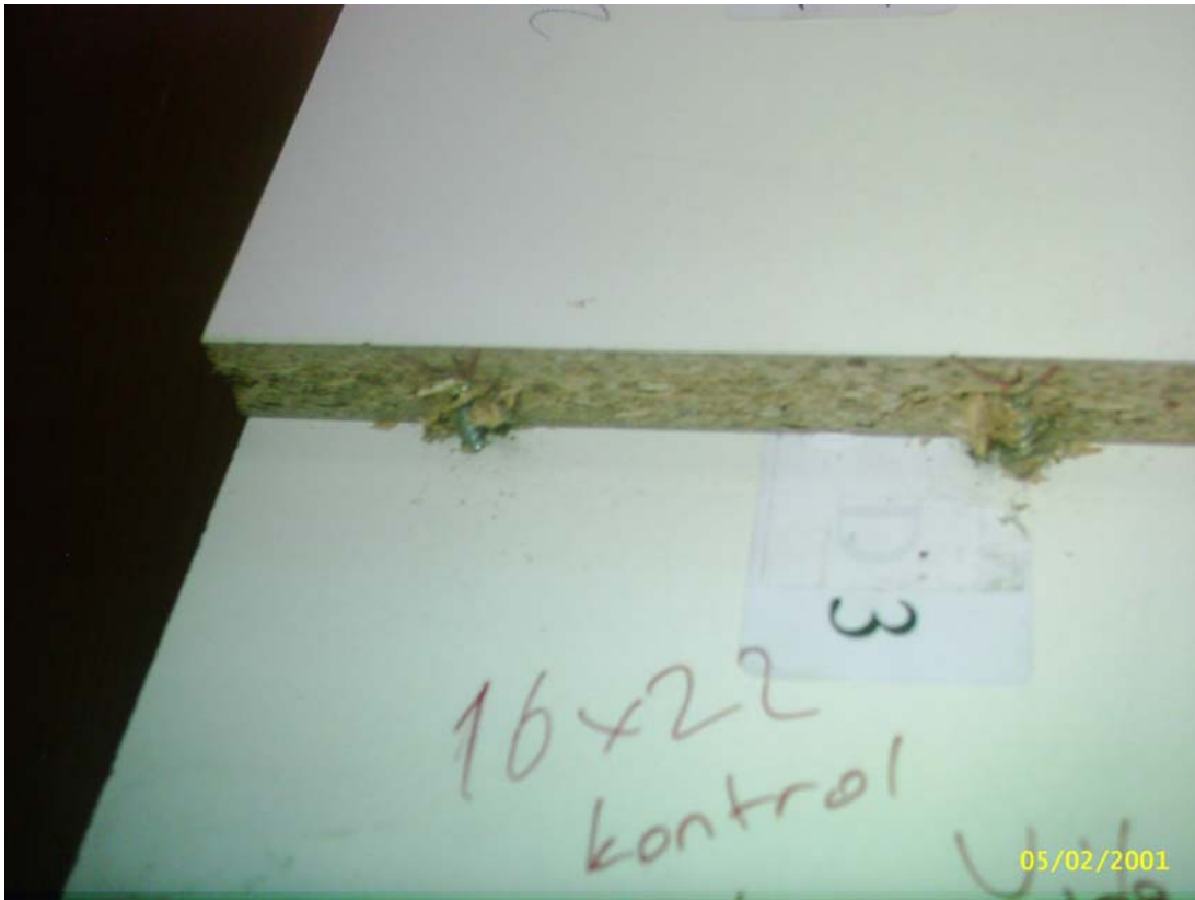
Şekil 5.9 Eğilme deneyinde Kontrol - 4 mm vida Suntalamda oluşan deformasyon.
