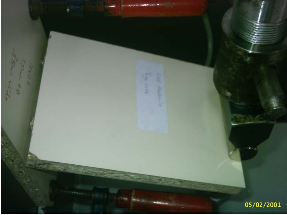
Şekil 5.12 Eğilme deneyinde 1,5 mm KD - 3,5 mm vida Suntalamda oluşan deformasyon.
