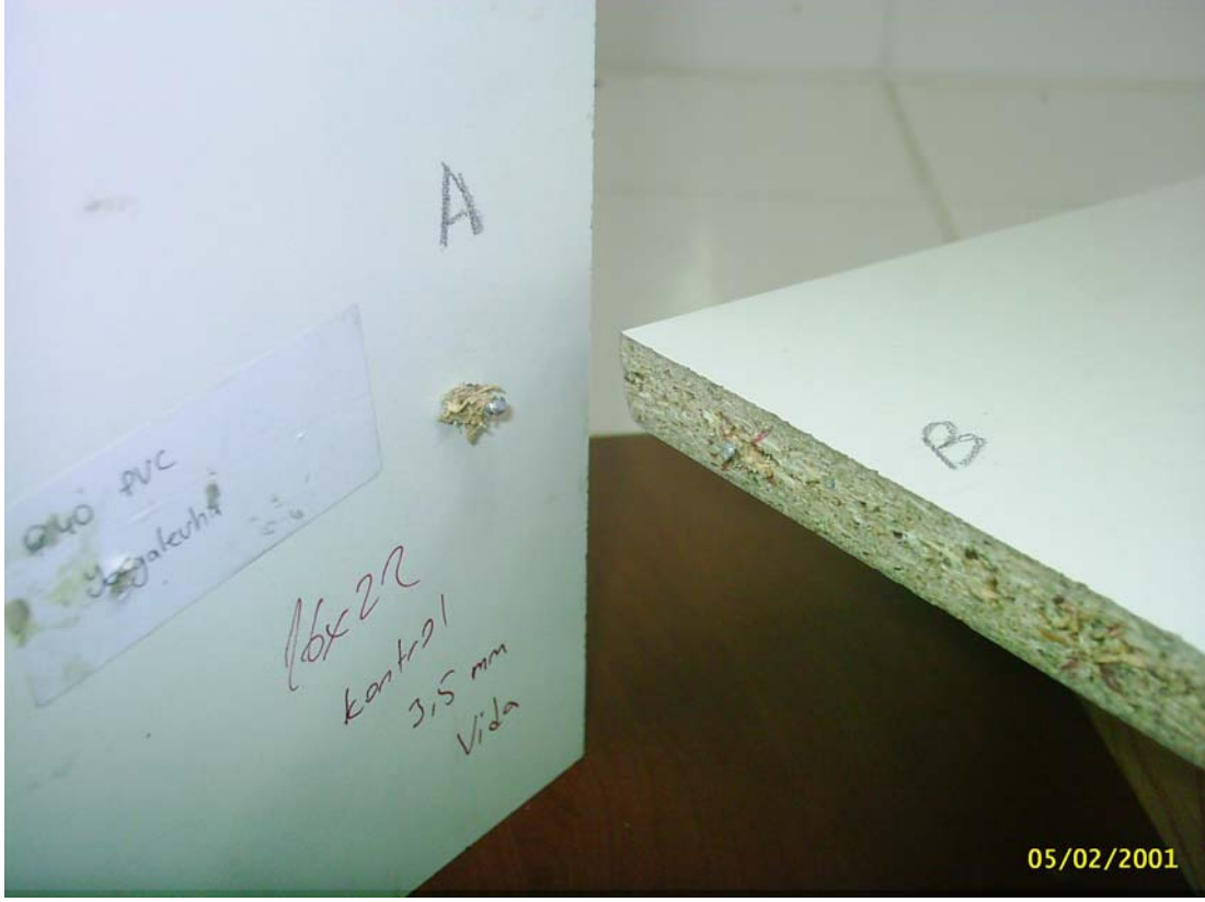
Şekil 5.10 Eğilme deneyinde Kontrol - 3,5 mm vida Suntalamda oluşan deformasyon.
