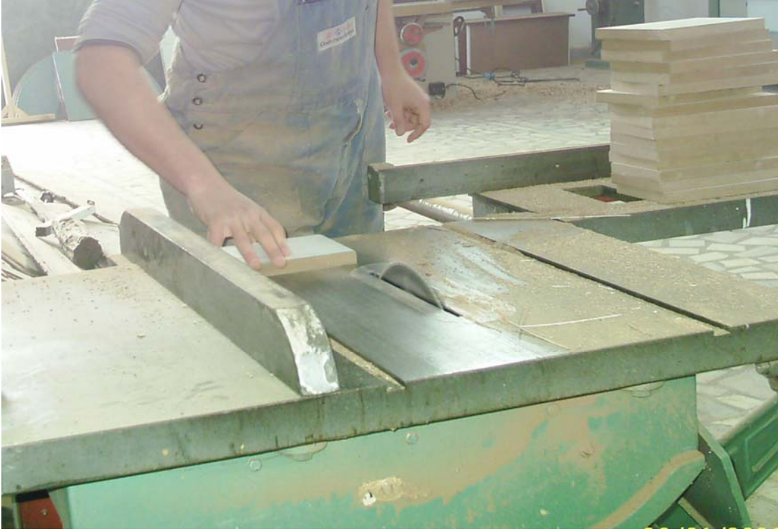
Şekil 4.4 Deney numunelerinin daire testere makinesinde kesilmesi.
