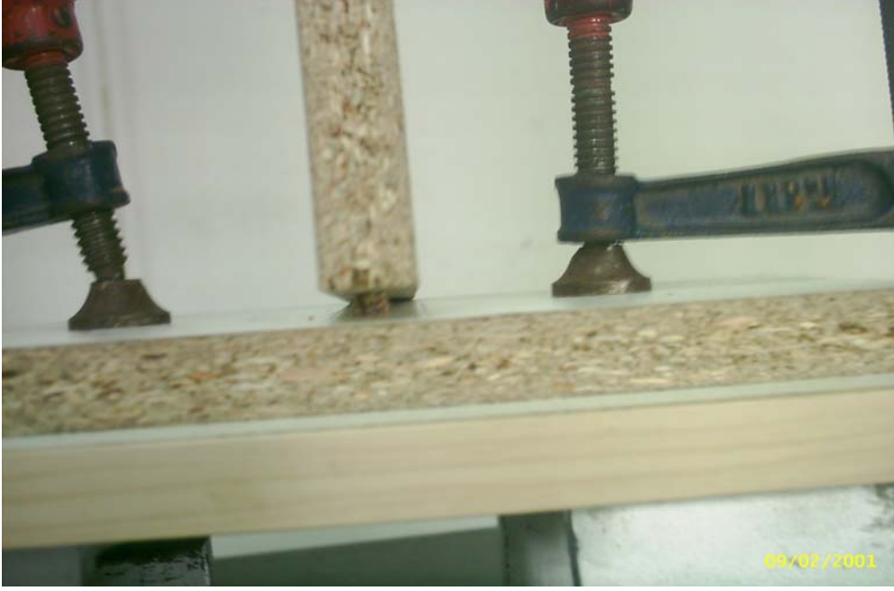
Şekil 5.22 Çekme deneyinde 1,5 mm KD - 3,5 mm vida suntalamda oluşan deformasyon.
