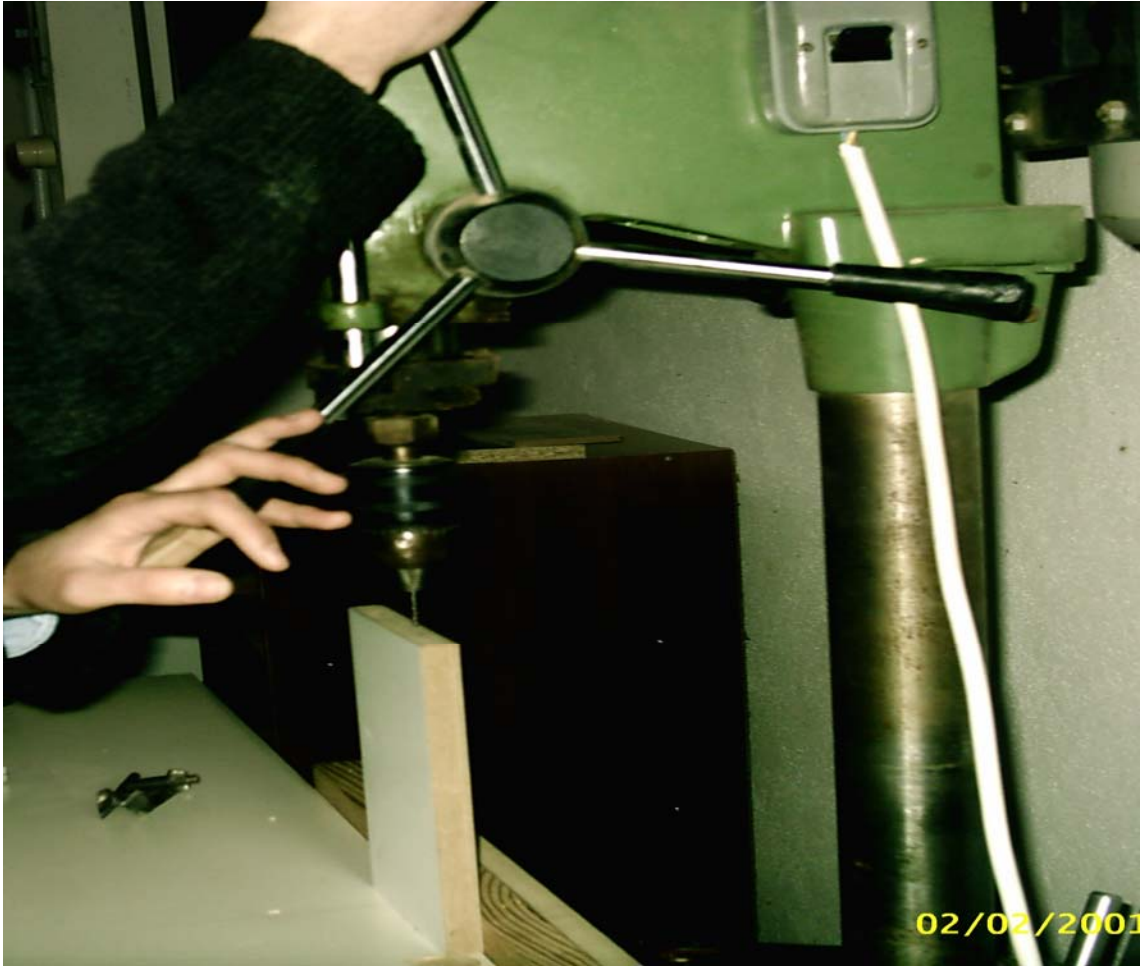
Şekil 4.6 Deney numunelerine klavuz deliği açılması.
