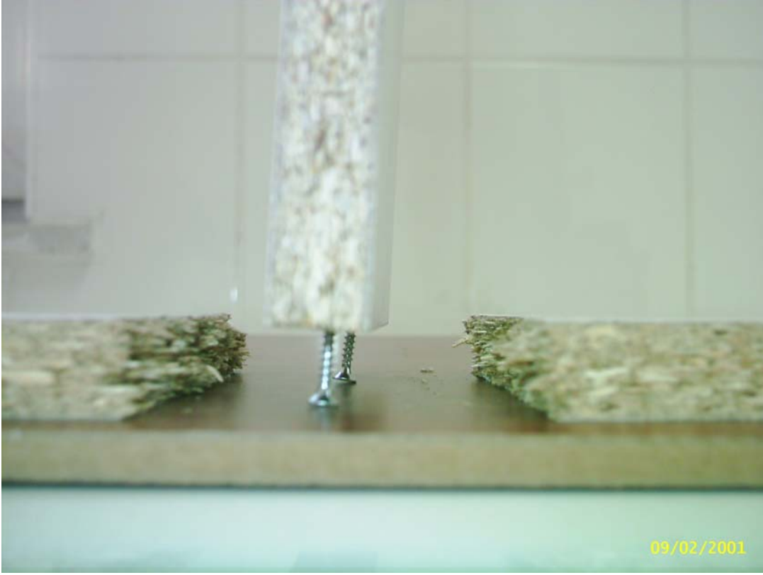
Şekil 5.16 Çekme deneyinde 2 mm KD - 4 mm vida suntalamda oluşan deformasyon.
