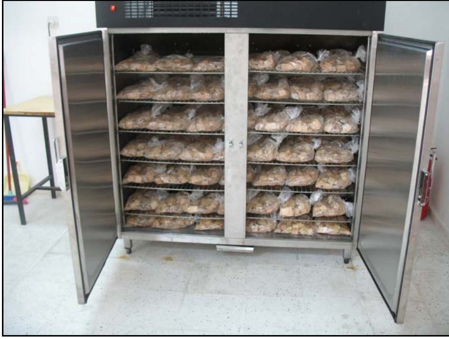
Şekil 2.7 C. subvermispora mantarı ile inoküle edilmiş P. nigra yongalarının inkübasyon sürelerini tamamladıkları iklimlendirme dolabı (Fotoğraf: Sezgin Koray Gülsoy 2008).
