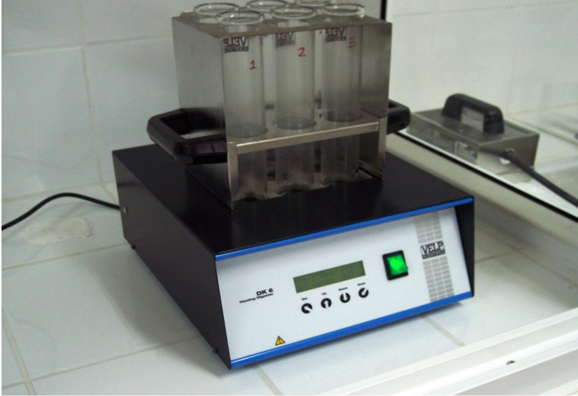
Sekil 2.11 Toprak örneklerinde Toplam N'i belirlemek amacıyla 420 °C'de 180 dakika yakma işlemi.
