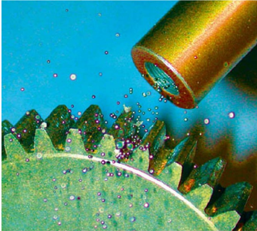
Şekil 1.2 Bir dişlinin dişlerinin bilyalı dövülmesi (Schulze 2004).
