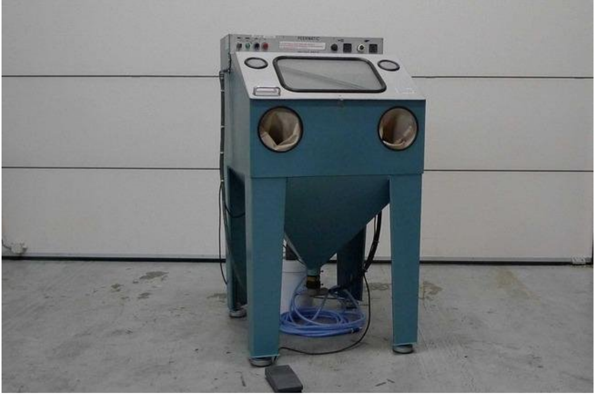
Şekil 1.6 Hava püskürtmeli bilyalı dövme cihazı. (URL-1, 2010)
