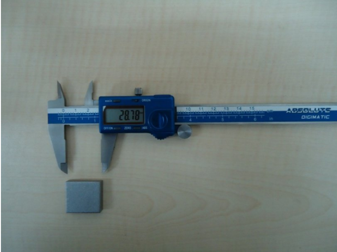
Şekil 3.1 AISI 1017 düşük karbonlu çelik numunesi.
