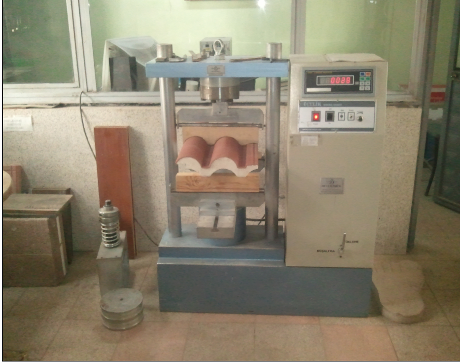
Şekil 4.4. Basma test cihazı.
