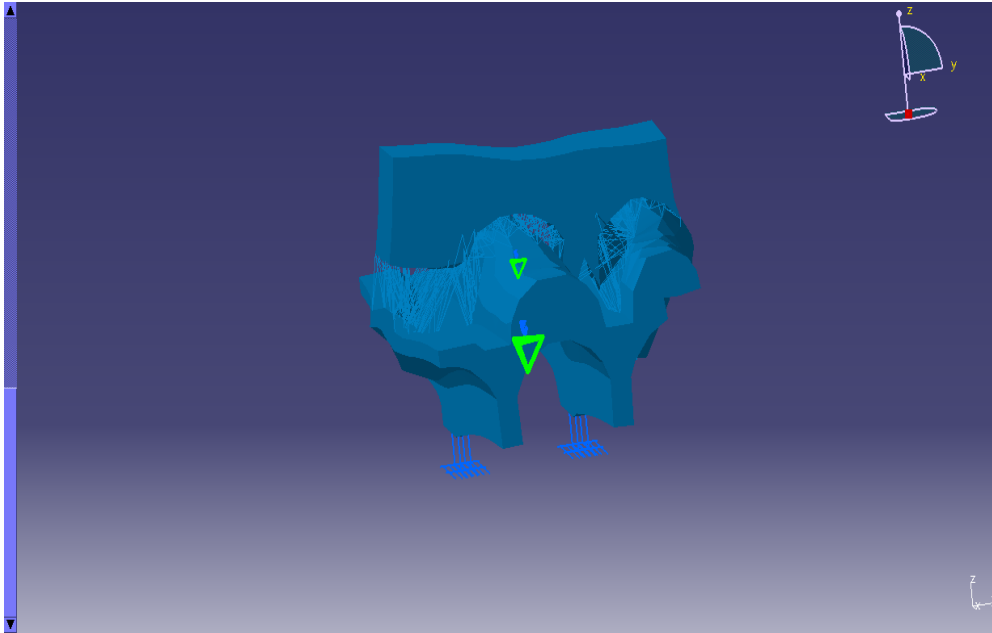
Şekil 5.12 Genleştirilmiş EPS sert köpüklü kiremitlerde oluşan deformasyon ve yoğun olduğu bölgeler.
