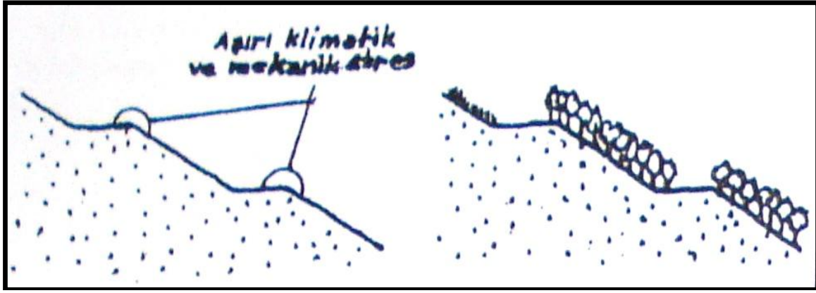
Şekil 1.11 Şevlerde aşırı bir mikroklimatik ve mekanik strese maruz bulunan keskin kenarların bitkilendirilerek korunması (Görcelioğlu 2002).
