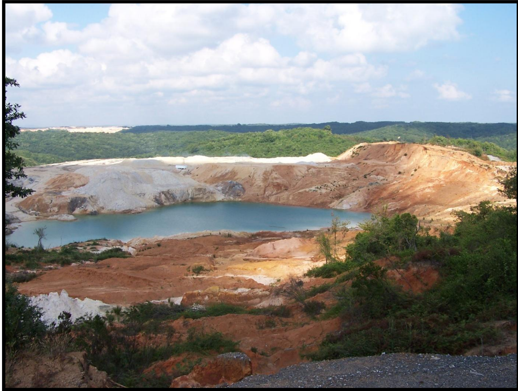
Şekil 1.7 Yüzey madenciliğinin hidrolojik yapıya etkisi.
