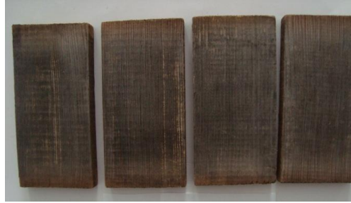
Şekil 3.15 6 ay (a) ve 12 ay (b) açık hava koşullarına maruz kalmış hiçbir koruyucu ile muamele edilmemiş düzgün yüzeyli sarıçam kontrol örnekleri.
