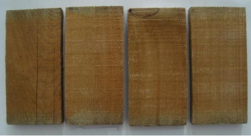
Şekil 3.18 3 ay (a), 6 ay (b) ve 12 ay (c) açık hava koşullarına maruz kalmış Imersol Aqua ile muamele edilmiş pürüzlü yüzeyli sarıçam örnekleri.
