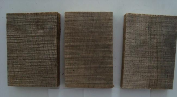
Şekil 3.10 6 ay (a) ve 12 ay (b) açık hava koşullarına maruz kalmış hiçbir koruyucu ile muamele edilmemiş pürüzlü yüzeyli kestane kontrol örnekleri.
