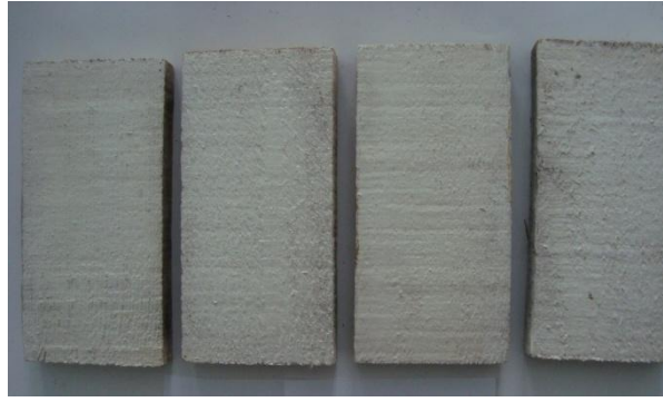
Şekil 3.16 3 ay (a), 6 ay (b) ve 12 ay (c) açık hava koşullarına maruz kalmış Paint ile muamele edilmiş pürüzlü yüzeyli sarıçam örnekleri.
