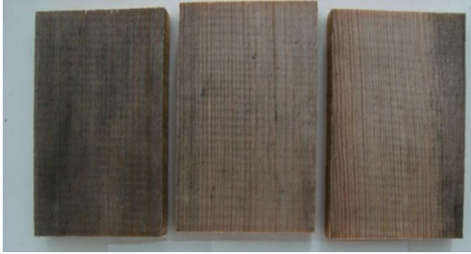
Şekil 3.15 6 ay (a) ve 12 ay (b) açık hava koşullarına maruz kalmış hiçbir koruyucu ile muamele edilmemiş düzgün yüzeyli sarıçam kontrol örnekleri.
