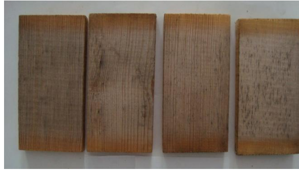
Şekil 3.12 3 ay (a), 6 ay (b) ve 12 ay (c) açık hava koşullarına maruz kalmış Stain ile muamele edilmiş düzgün yüzeyli sarıçam örnekleri.
