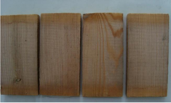
Şekil 3.12 3 ay (a), 6 ay (b) ve 12 ay (c) açık hava koşullarına maruz kalmış Stain ile muamele edilmiş düzgün yüzeyli sarıçam örnekleri.
