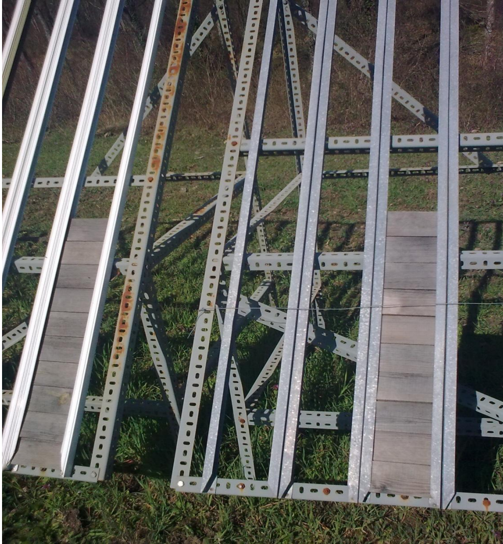
Şekil 2.3 Örneklerin panellere yerleştirilmesi.
