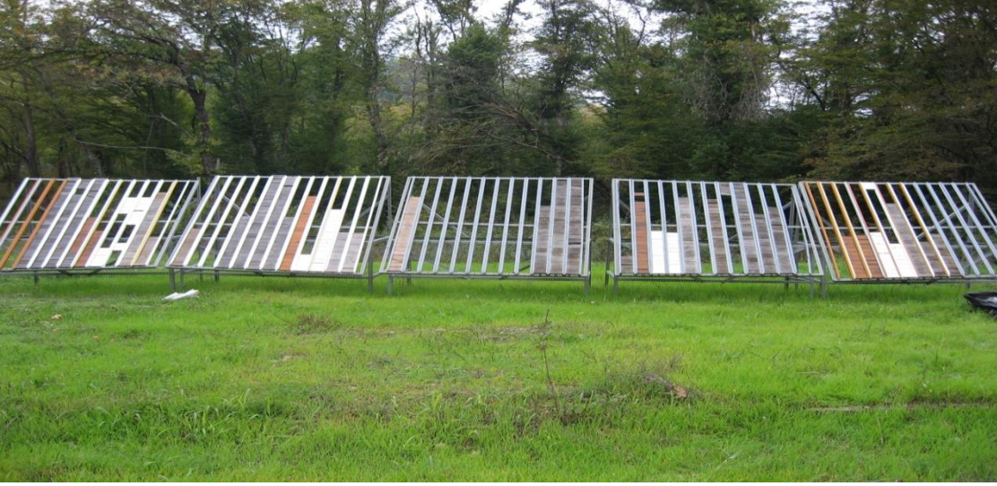
Şekil 2.2 Deney örneklerinin yerleştirdiği metal paneller.
