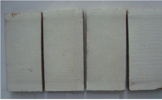
Şekil 3.10 6 ay (a) ve 12 ay (b) açık hava koşullarına maruz kalmış hiçbir koruyucu ile muamele edilmemiş pürüzlü yüzeyli kestane kontrol örnekleri.
