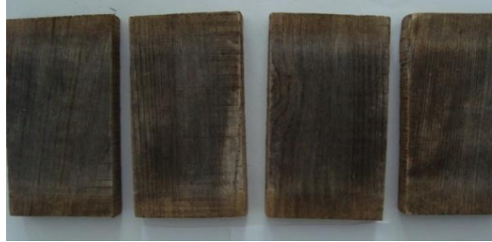
Şekil 3.5 6 ay (a) ve 12 ay (b) açık hava koşullarına maruz kalmış hiçbir koruyucu ile muamele edilmemiş düzgün yüzeyli kestane kontrol örnekleri.
