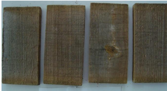
Şekil 3.19 3 ay (a), 6 ay (b) ve 12 ay (c) açık hava koşullarına maruz kalmış Tanalith-E ile empenye edilmiş pürüzlü yüzeyli sarıçam örnekleri.
