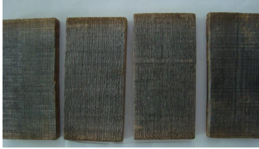
Şekil 3.18 3 ay (a), 6 ay (b) ve 12 ay (c) açık hava koşullarına maruz kalmış Imersol Aqua ile muamele edilmiş pürüzlü yüzeyli sarıçam örnekleri.
