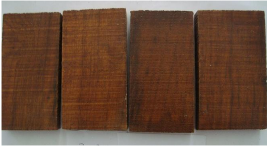
Şekil 3.6 3 ay (a), 6 ay (b) ve 12 ay (c) açık hava koşullarına maruz kalmış Paint ile muamele edilmiş pürüzlü yüzeyli kestane örnekleri.
