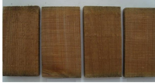
Şekil 3.18 3 ay (a), 6 ay (b) ve 12 ay (c) açık hava koşullarına maruz kalmış Imersol Aqua ile muamele edilmiş pürüzlü yüzeyli sarıçam örnekleri.
