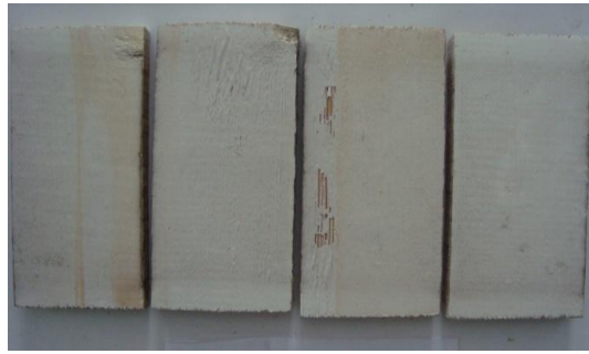
Şekil 3.10 6 ay (a) ve 12 ay (b) açık hava koşullarına maruz kalmış hiçbir koruyucu ile muamele edilmemiş pürüzlü yüzeyli kestane kontrol örnekleri.
