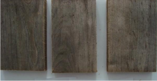
Şekil 3.5 6 ay (a) ve 12 ay (b) açık hava koşullarına maruz kalmış hiçbir koruyucu ile muamele edilmemiş düzgün yüzeyli kestane kontrol örnekleri.
