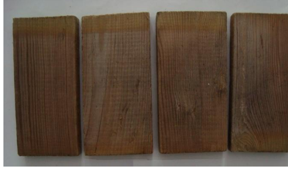
Şekil 3.14 3 ay (a), 6 ay (b) ve 12 ay (c) açık hava koşullarına maruz kalmış Tanalith-E ile muamele edilmiş düzgün yüzeyli sarıçam örnekleri.
