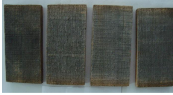
Şekil 3.20 6 ay (a) ve 12 ay (b) açık hava koşullarına maruz kalmış hiçbir koruyucu ile muamele edilmemiş pürüzlü yüzeyle sarıçam kontrol örnekleri.
