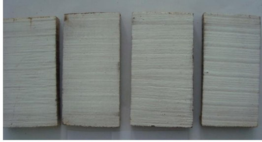
Şekil 3.6 3 ay (a), 6 ay (b) ve 12 ay (c) açık hava koşullarına maruz kalmış Paint ile muamele edilmiş pürüzlü yüzeyli kestane örnekleri.
