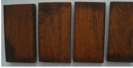
Şekil 3.2 3 ay (a), 6 ay (b) ve 12 ay (c) açık hava koşullarına maruz kalmış Stain ile muamele edilmiş düzgün yüzeyli kestane örnekleri.
