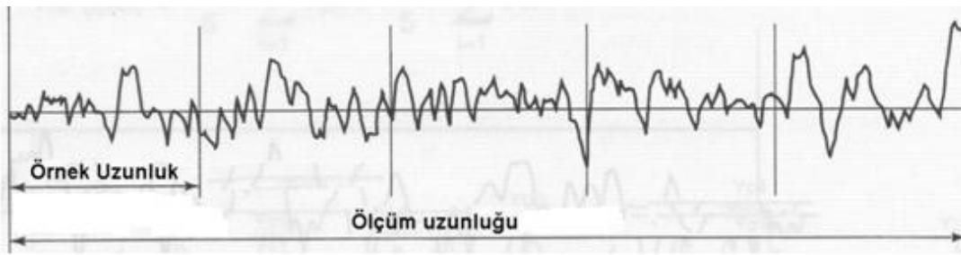
Şekil 2.8. Yüzey pürüzlülüğü ölçüm uzunluğu ve grafik çıktısı örneği.
