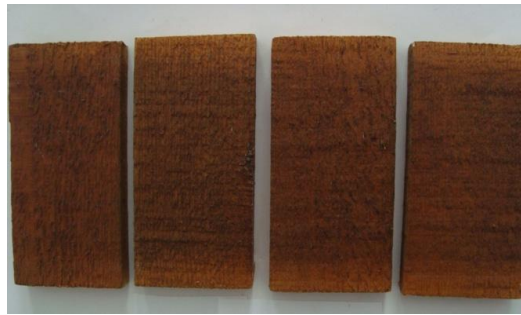
Şekil 3.17 3 ay (a), 6 ay (b) ve 12 ay (c) açık hava koşullarına maruz kalmış Stain ile muamele edilmiş pürüzlü yüzeyli sarıçam örnekleri.
