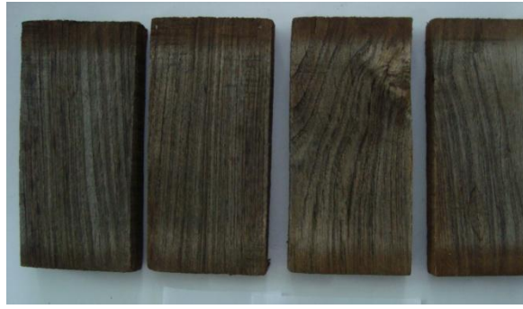
Şekil 3.4 3 ay (a), 6 ay (b) ve 12 (c) ay açık hava koşullarına maruz kalmış Tanalith-E ile empenye edilmiş düzgün yüzeyli kestane örnekleri.
