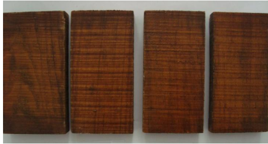
Şekil 3.7 3 ay (a), 6 ay (b) ve 12 ay (c) açık hava koşullarına maruz kalmış Stain ile muamele edilmiş pürüzlü yüzeyli kestane örnekleri.
