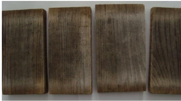
Şekil 3.3 3 ay (a), 6 ay (b) ve 12 ay (c) açık hava koşullarına maruz kalmış Imersol Aqua ile muamele edilmiş düzgün yüzeyli kestane örnekleri.
