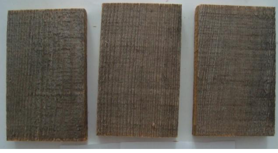
Şekil 3.20 6 ay (a) ve 12 ay (b) açık hava koşullarına maruz kalmış hiçbir koruyucu ile muamele edilmemiş pürüzlü yüzeyle sarıçam kontrol örnekleri.
