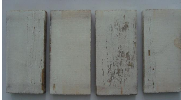
Şekil 3.11 3 ay (a), 6 ay (b) ve 12 ay (c) açık hava koşullarına maruz kalmış Paint ile muamele edilmiş düzgün yüzeyli sarıçam örnekleri.
