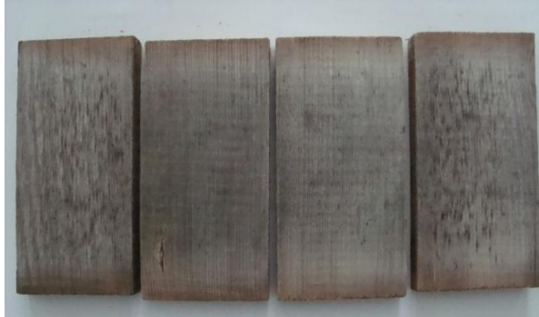
Şekil 3.13 3 ay (a), 6 ay (b) ve 12 ay (c) açık hava koşullarına maruz kalmış Imersol Aqua ile muamele edilmiş düzgün yüzeyli sarıçam örnekleri.
