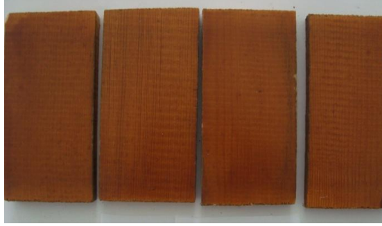
Şekil 3.12 3 ay (a), 6 ay (b) ve 12 ay (c) açık hava koşullarına maruz kalmış Stain ile muamele edilmiş düzgün yüzeyli sarıçam örnekleri.
