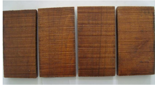
Şekil 3.6 3 ay (a), 6 ay (b) ve 12 ay (c) açık hava koşullarına maruz kalmış Paint ile muamele edilmiş pürüzlü yüzeyli kestane örnekleri.
