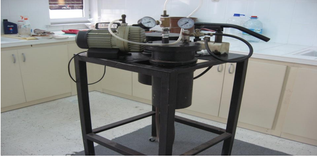
Şekil 2.16 Emprenye işleminin yapıldığı düzenek.
