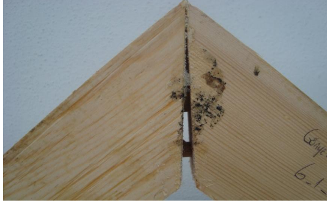
Şekil 3.26 Diyagonal çekme deneyinde gönyeburun kavelalı birleştirme türü kırılma tipi (1.tip).
