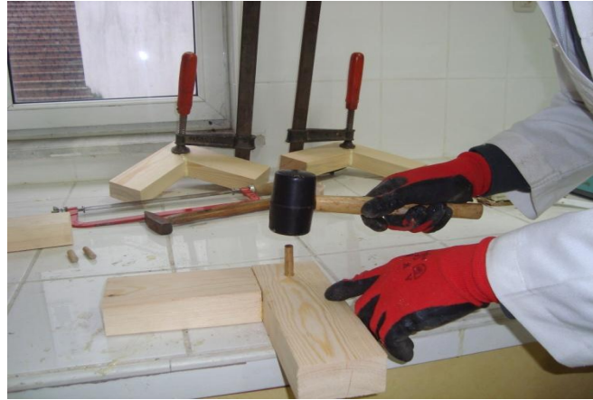
Şekil 2.16 Kavela deliği açma (a), kavela örneği (b), kavelanın yuvasına yerleştirilmesi (c).
