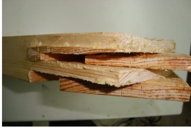
Şekil 3.9 Diyagonal basınç deneyinde asimetrik lambalı zıvanalı birleştirme türü kırılma tipi (2.tip).
