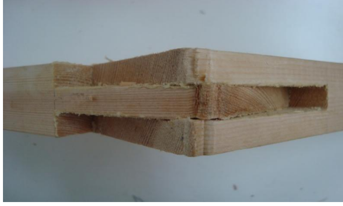
Şekil 3.20 Diyagonal çekme deneyinde tek lambalı zıvanalı birleştirme türü kırılma tipi (1.tip).
