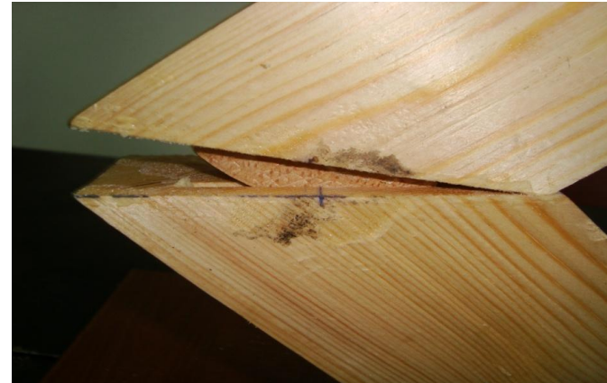
Şekil 3.16 Diagonal basınç deneyinde bisküvili birleştirme türü kırılma tipi (1.tip).
