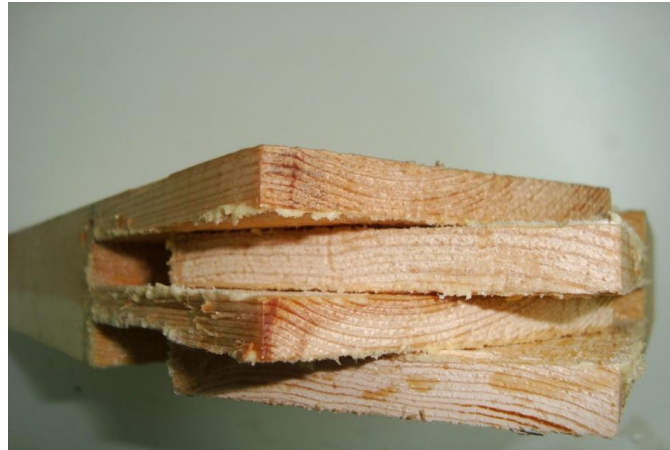
Şekil 3.10 Diyagonal basınç deneyinde asimetrik lambalı zıvanalı birleştirme türü kırılma tipi (1.tip).
