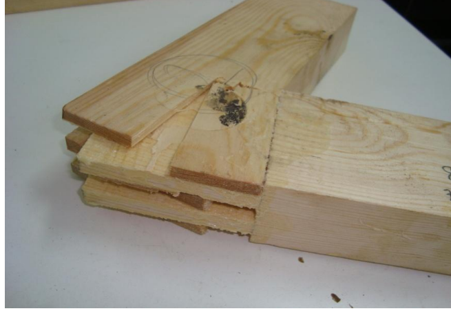
Şekil 3.5 Diyagonal basınç deneyinde çift lambalı zıvanalı birleştirme türü kırılma tipi (2.tip).
