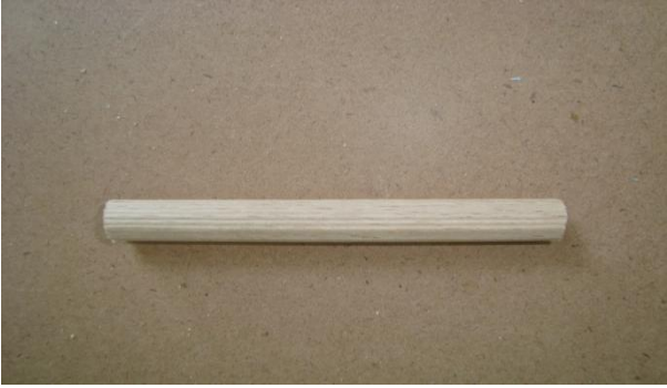
Şekil 2.18 Baş kesme işlemi (a), kavala deliği açma (b), kavala örneği (c), yuvasına yerleştirilmiş kavala (d).
