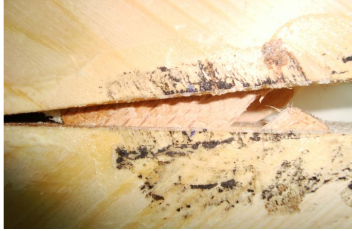
Şekil 3.17 Diyagonal basınç deneyinde bisküvili birleştirme türü kırılma tipi (2.tip).
