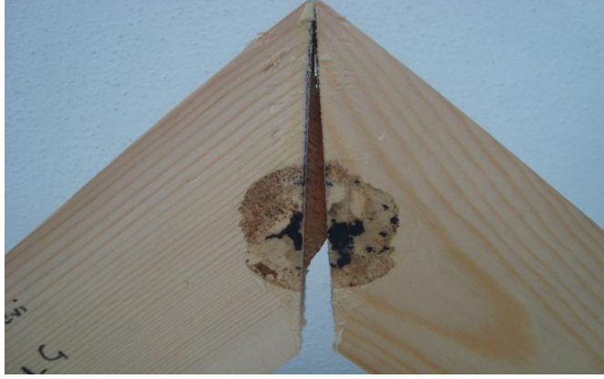
Şekil 3.27 Diyagonal çekme deneyinde bisküvili birleştirme türü kırılma tipi (1.tip).
