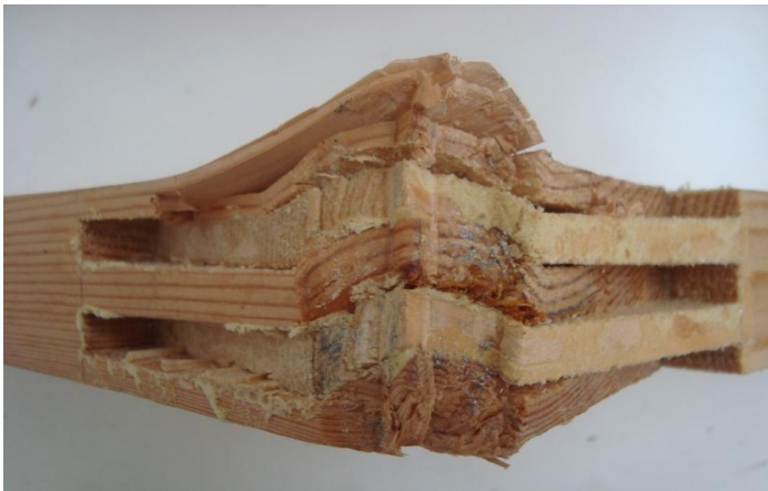
Şekil 3.22 Diyagonal çekme deneyinde çift lambalı zıvanalı birleştirme türü kırılma tipi (2.tip).
