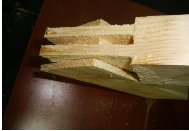
Şekil 3.6 Diyagonal basınç deneyinde çift lambalı zıvanalı birleştirme türü kırılma tipi (1.tip).
