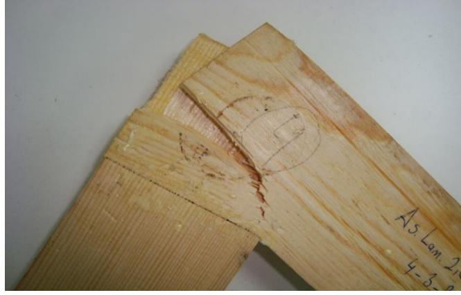
Şekil 3.11 Diagonal basınç deneyinde asimetrik lambalı zıvanalı birleştirme türü kırılma tipi (2.tip).
