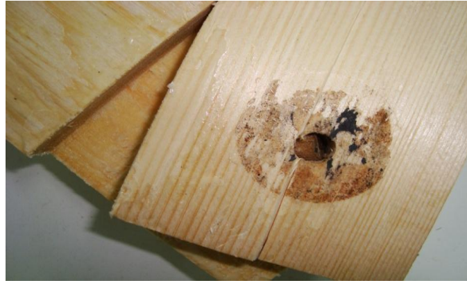
Şekil 3.12 Diagonal basınç deneyinde tek lambalı kavelalı birleştirme türü kırılma tipi (2.tip).
