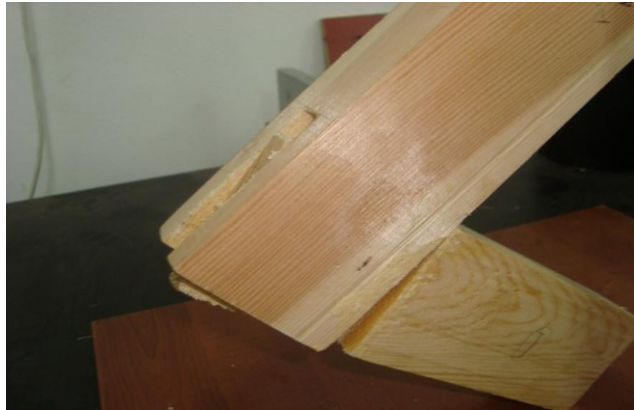
Şekil 3.3 Diyagonal basınç deneyinde tek lambalı zıvanalı birleştirme türü kırılma tipi (1.tip).
