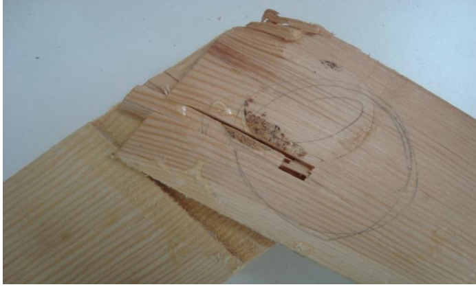
Şekil 3.21 Diyagonal çekme deneyinde çift lambalı zıvanalı birleştirme türü kırılma tipi (2.tip).
