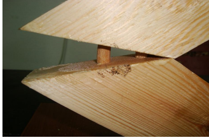
Şekil 3.14 Diagonal basınç deneyinde gönyeburun kavelalı birleştirme türü kırılma tipi (1.tip).
