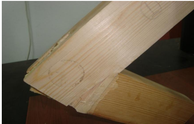
Şekil 3.4 Diyagonal basınç deneyinde tek lambalı zıvanalı birleştirme türü kırılma tipi (2.tip).
