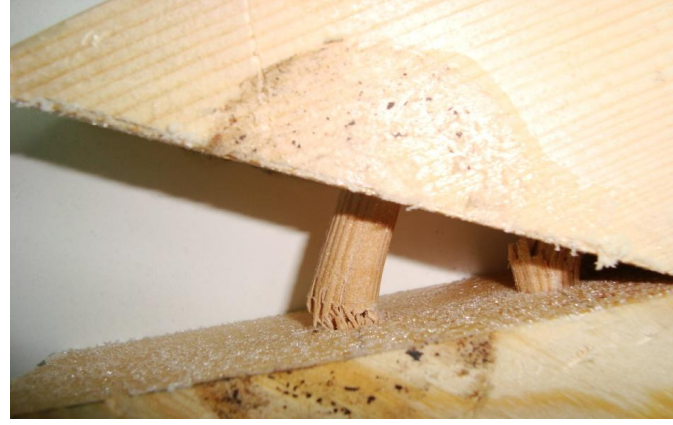
Şekil 3.15 Diagonal Basınç deneyinde gönyeburun kavelalı birleştirme türü kırılma tipi (2.tip).
