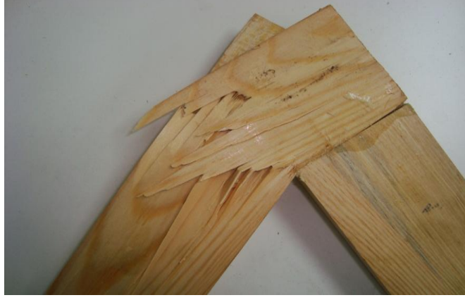
Şekil 3.8 Diyagonal basınç deneyinde çift lambalı zıvanalı birleştirme türü kırılma tipi (2.tip).
