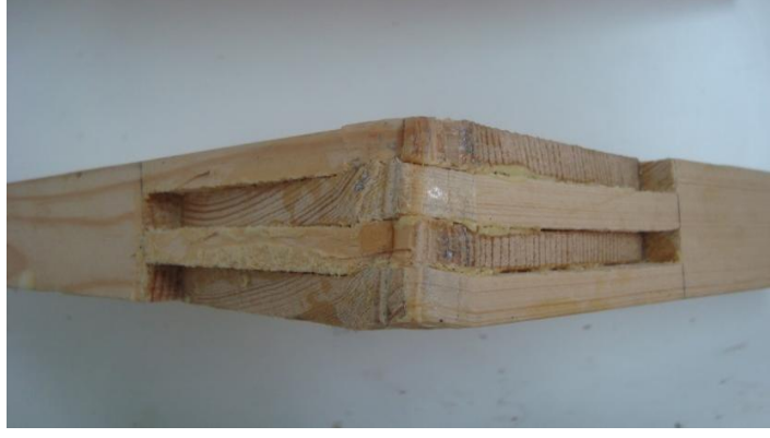
Şekil 3.23 Diyagonal çekme deneyinde asimetrik lambalı zıvanalı birleştirme türü kırılma tipi (1.tip).
