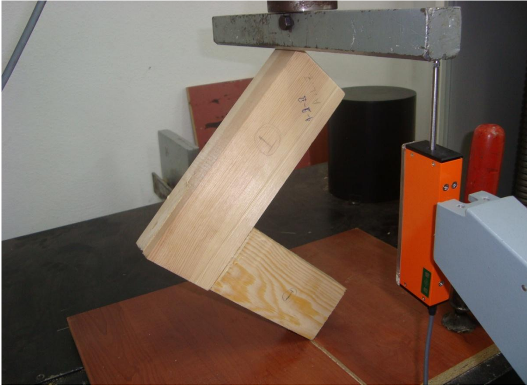
Şekil 2.21 Diyagonal basınç deneyi düzenegi.
