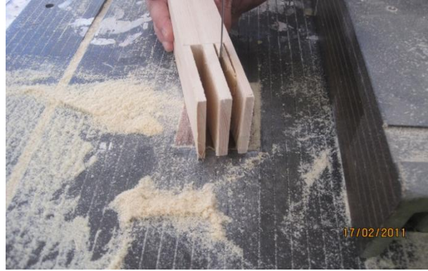
Şekil 2.12 Zıvana kenarlarının alınması (a), zıvana ortasının alınması (b), lamba açılması (c).
