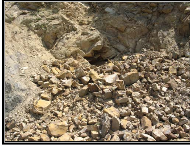
Şekil 3.88 İyasegeçidi köyünde meydana göçükle işletilmekten vazgeçilen kömür madeni ocağı.
