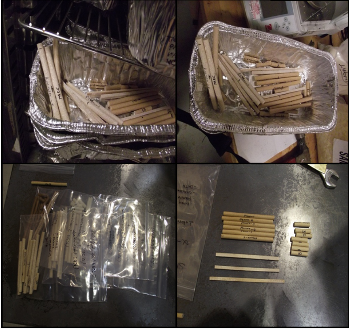
Şekil 3.5 Köpüklendirilmiş kompozitlerin kurutulması ve test örneklerinin hazırlanması (Fotoğraf: Deniz Aydemir 2011).
