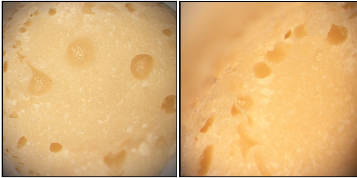
Şekil 4.25 Köpükendirilmiş SMA – nişasta kompozitinin stereo mikroskop görüntüleri.
