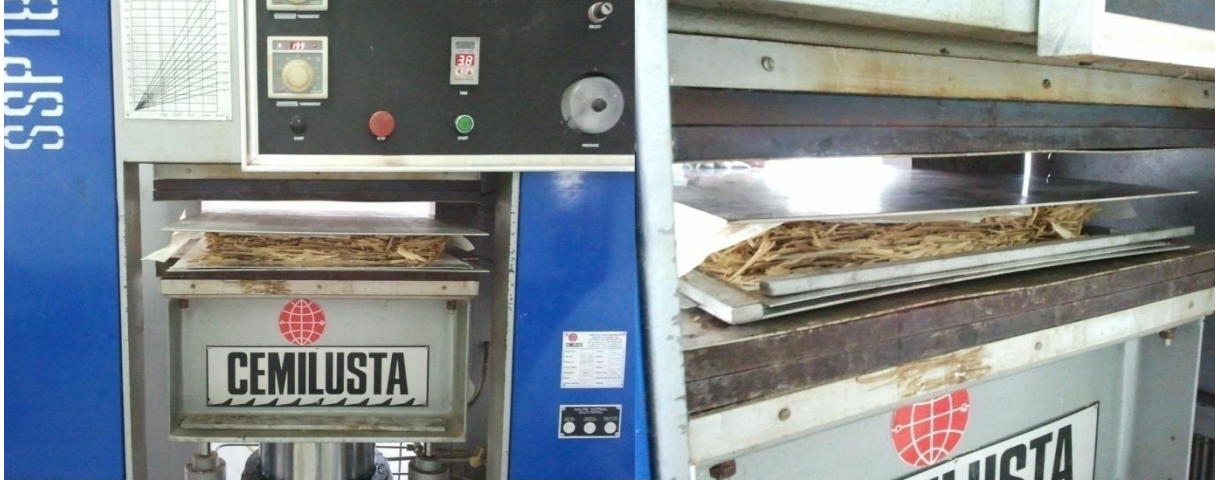
Şekil 2.3 Levha taslağının hidrolik preste preslenmesi.
