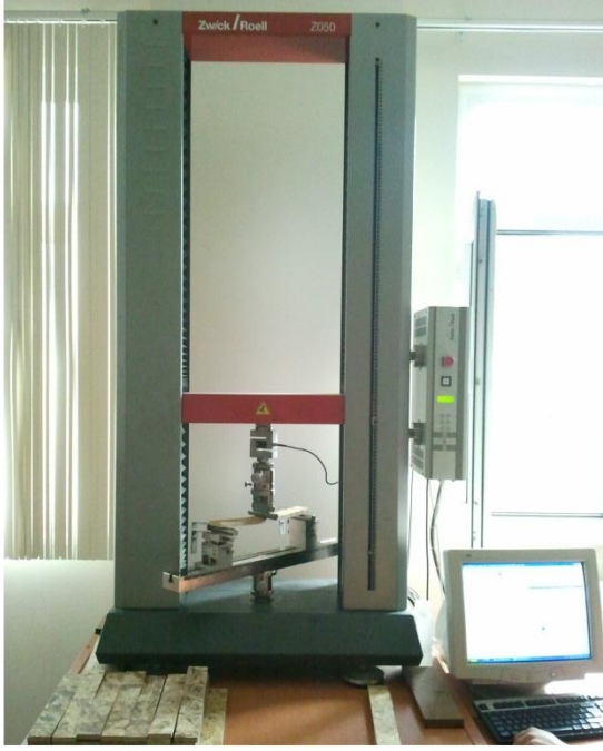
Şekil 2.7 Levhaların örneklerinin eğilme testinin uygulanması.
