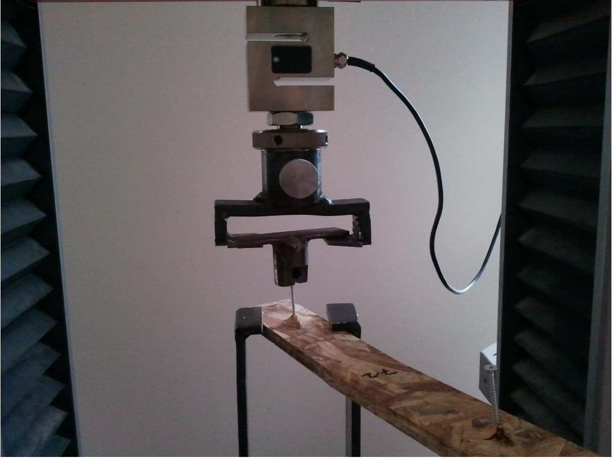
Şekil 2.10 Örneklerin yüzeye dik vida tutma direncinin test edilmesi.
