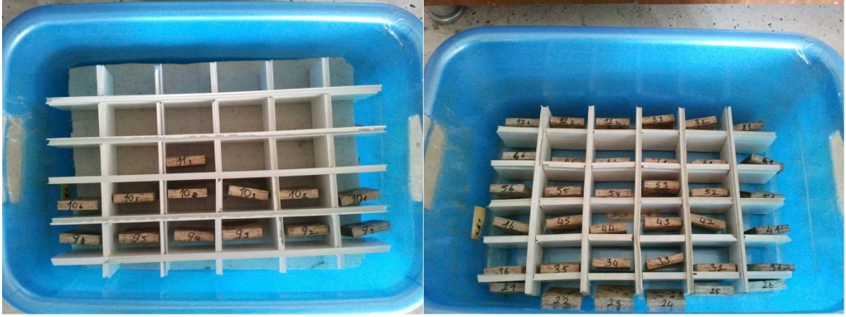
Şekil 2.6 Levhaların su alma ve şişme deneyi.
