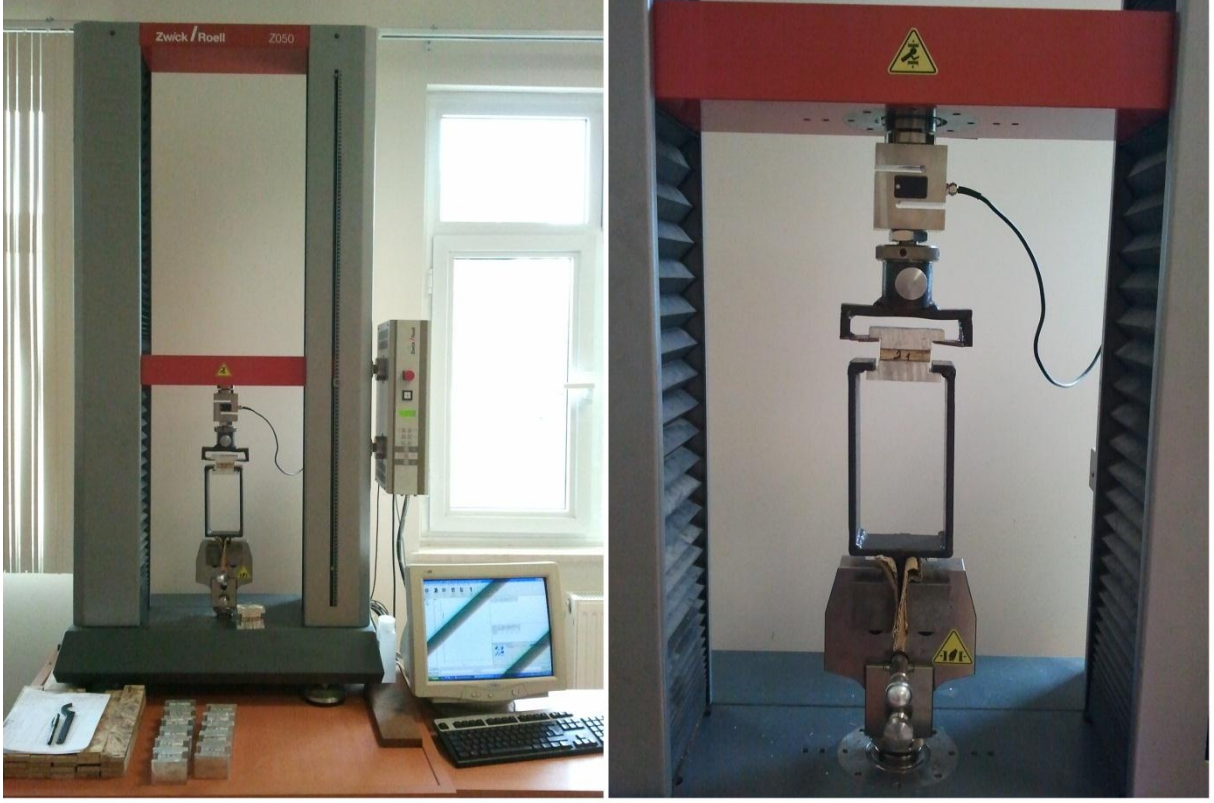
Şekil 2.9 Levha yüzeyine dik yönde çekme direnci test edilmesi.
